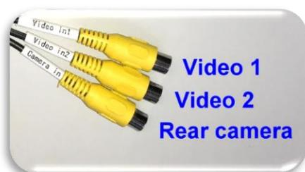
Nous recommandons de **alimenter la caméra arrière en utilisant le ROUGE (12 V) + NOIR (GND) fils de l'interface** au lieu de contre-jour pour éviter la distorsion de l'image de la caméra, surtout lorsque le moteur tourne!
