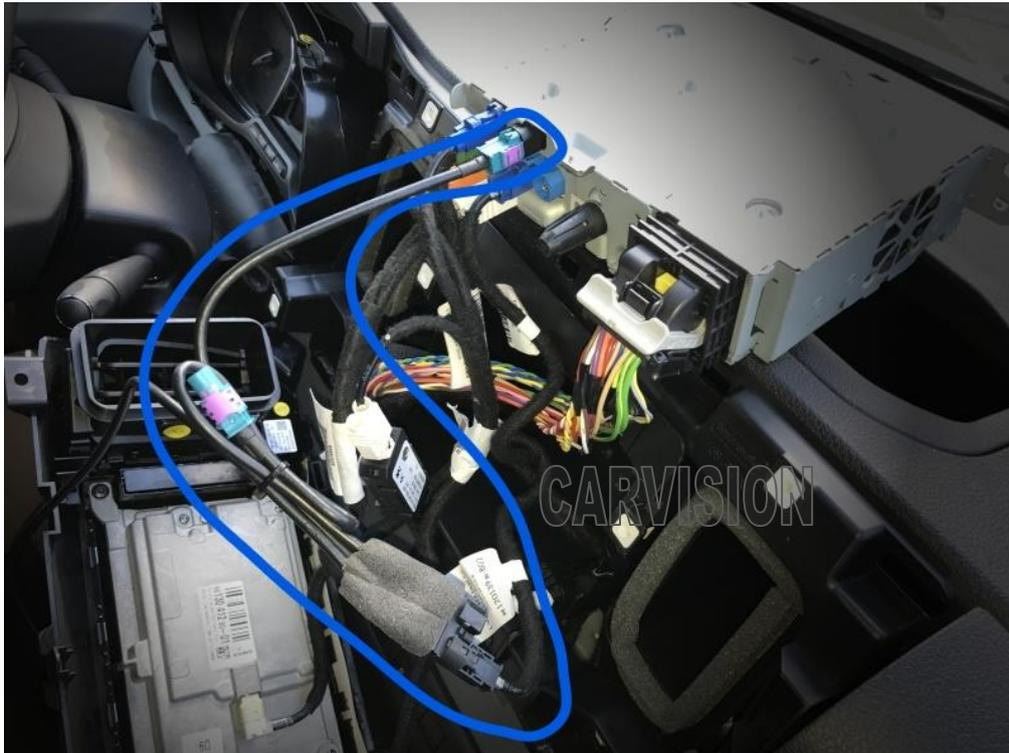
Connectez le connecteur 4 + 2P au boîtier d'interface
