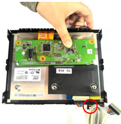
9 、 le PCB fille doit être accroché aux 2 pôles ici 。
