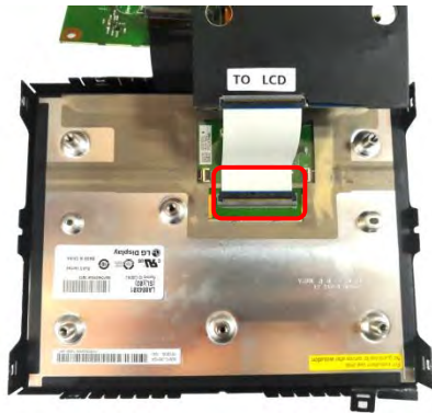
sept 、 le ruban 68Pin du PCB fille insère dans la prise OEM.
