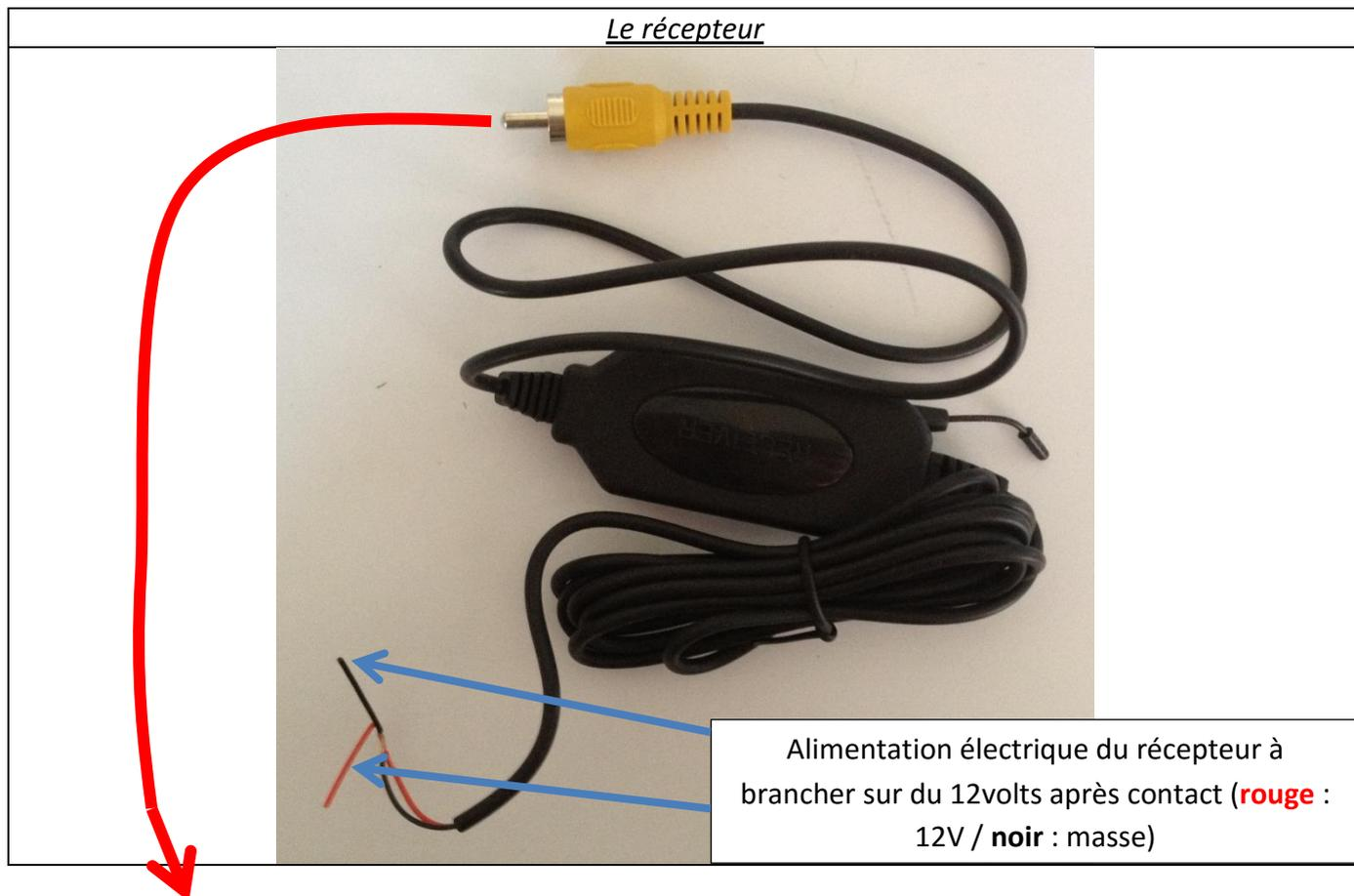
**La prise vidéo de la caméra de recul se branche sur l'entrée vidéo de l'autoradio. En fonction du modèle elle se nomme « Camera In » ou « Camera input » ou « Back in » ou « CCD video in ».**
