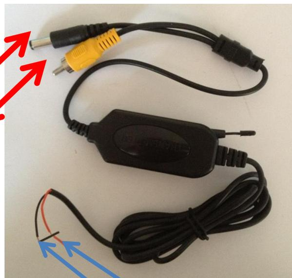
Alimentation électrique de la caméra et de l'émetteur à relier sur le 12 volts du feu de recul. (**Rouge** 12Volts et **Noir** la masse)
