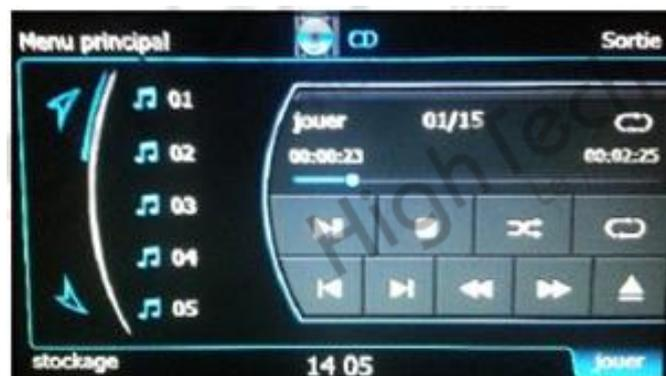
1. Le système permet l'enregistrement de 19 CD (maximum de 4 Go). Cette fonction appelée VCDC est accessible en appuyant sur «stockage » lors de la lecture d'un CD.
