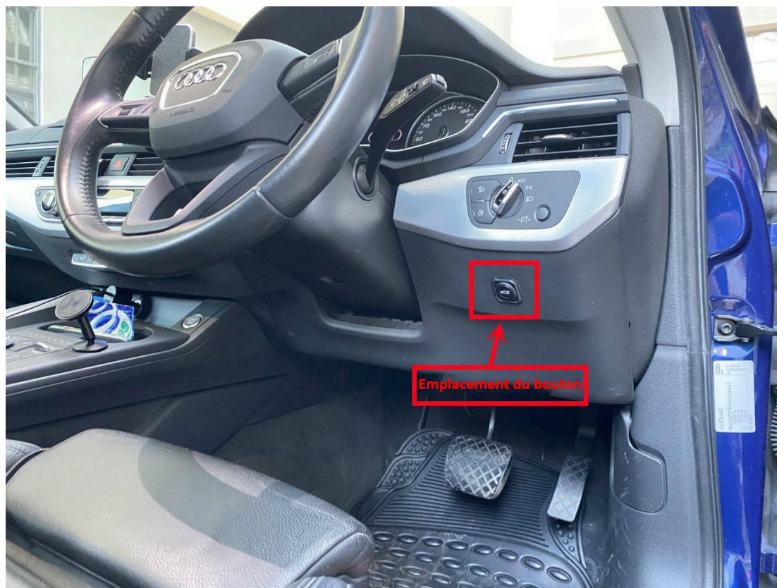
position d'installation du bouton d'habitacle
