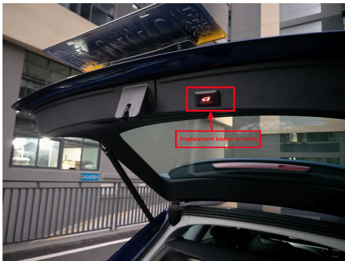
Position d'installation du bouton de coffre
