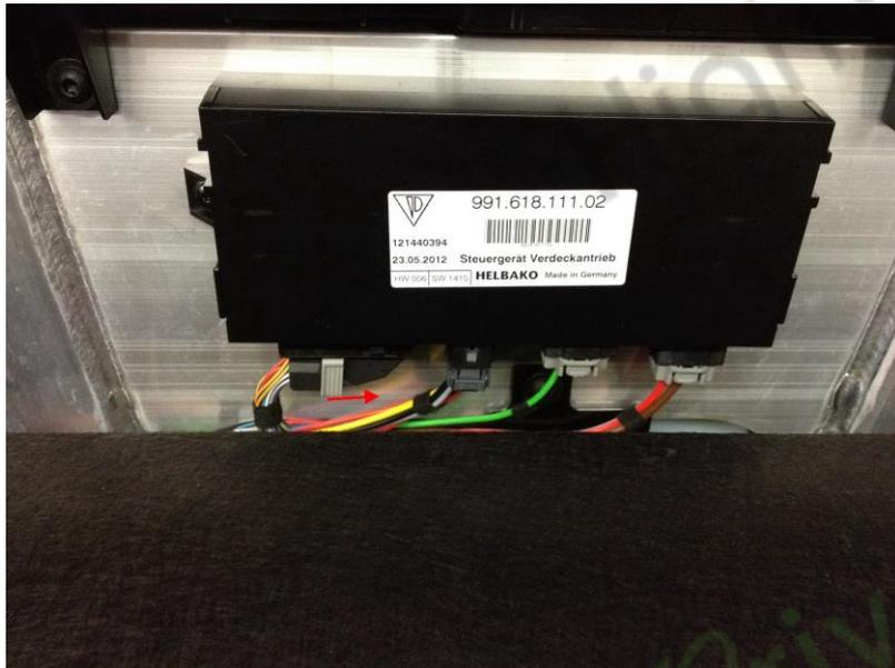
6. Unité de commande supérieure, vue à travers la fenêtre arrière. Retirez le gros bouchon noir en retournant le levier de verrouillage. Le levier est maintenu en place par une petite languette de verrouillage. Voir la fiche équivalente sur le faisceau de câbles SmartTOP fourni pour référence.
