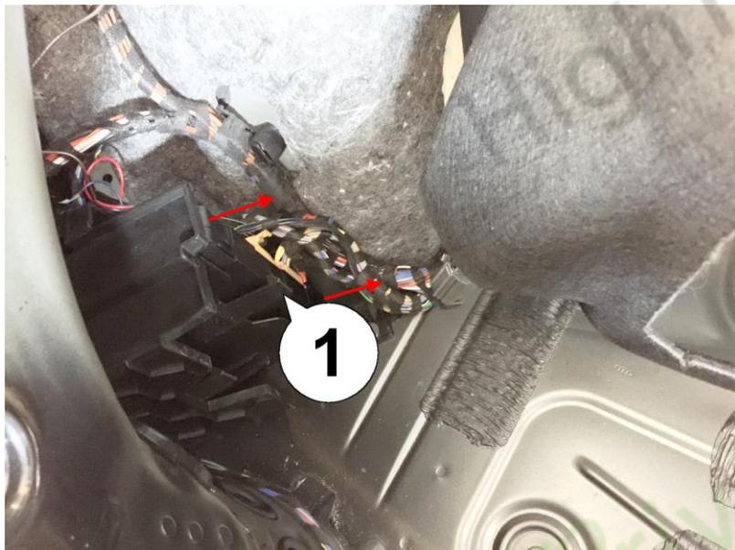
6. Le boîtier de commande supérieur comporte deux connecteurs jaunes et deux connecteurs noirs. Il est monté dans un support et maintenu en place par un crochet en plastique (1). Pliez soigneusement le crochet vers vous et faites glisser le module supérieur hors du support (flèches).
