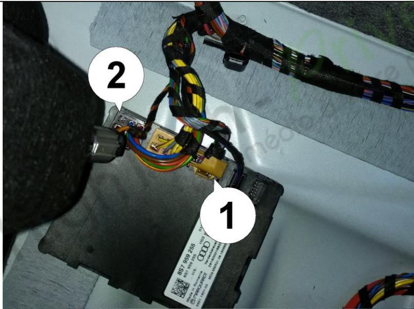
7. Débranchez la prise de données jaune (1) et la prise d'alimentation noire (2) en appuyant fortement sur les leviers de verrouillage sur le côté (déverrouillé) afin de connecter le faisceau de câblage personnalisé Mods4cars entre les deux.
