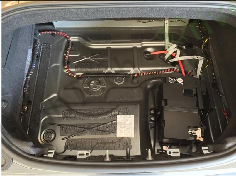
3. Retirez tous les inserts en mousse de polystyrène et le couvercle en plastique sur le mécanisme de verrouillage. Soulevez le couvercle en tirant vers le haut avec une certaine force. Il est simplement enclenché.
