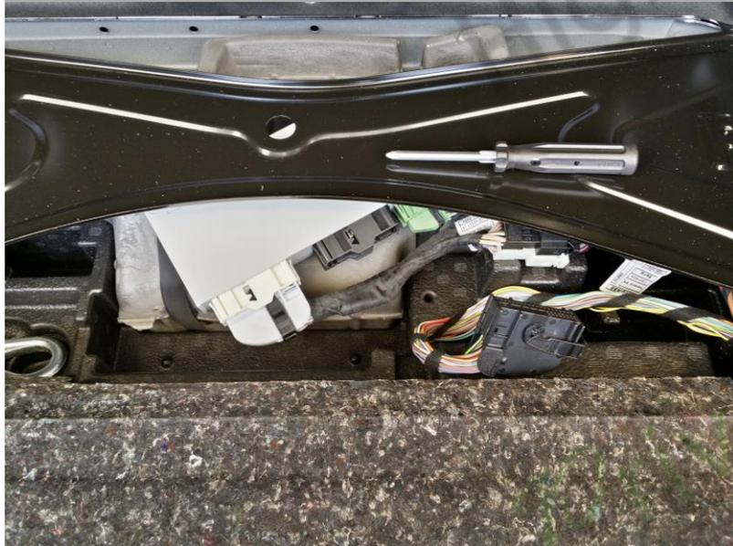
4. Maintenant que la fiche est déverrouillée, vous pouvez la retirer du contrôleur de capote. Le harnais en T fourni a une fiche identique. Connectez-le au contrôleur de capote. Lors de la connexion des fiches, insérez-les soigneusement en vous assurant que les guides sont alignés. Ce sont des connecteurs à force d'insertion nulle, ils doivent donc glisser ensemble facilement et sans aucune force.
