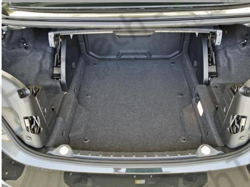
1. Commencez avec le toit fermé, la voiture déverrouillée et le contact coupé. Ouvrez le coffre (couvercle de coffre), rétractez le plateau de séparation des bagages, puis soulevez et retirez le plancher de la moquette.
