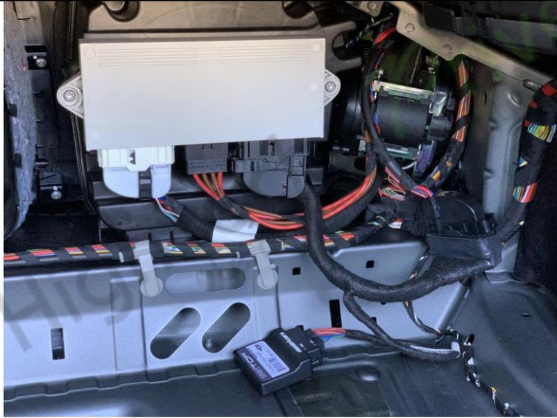
12. Enfin, connectez le module smartTOP au connecteur à 16 voies du faisceau. Appuyez une fois sur le bouton de déverrouillage de votre télécommande porte-clés et le voyant de données vert devrait maintenant clignoter, indiquant que le module est prêt à l'emploi. Reportez-vous au manuel d'utilisation et de programmation pour configurer le module SmartTop.
