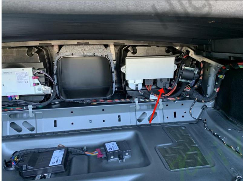
10. Derrière le mur de droite se trouve le boîtier de commande de toit blanc. Le connecteur noir le plus à droite doit être retiré en appuyant sur la languette de verrouillage tout en retournant le levier de verrouillage.
