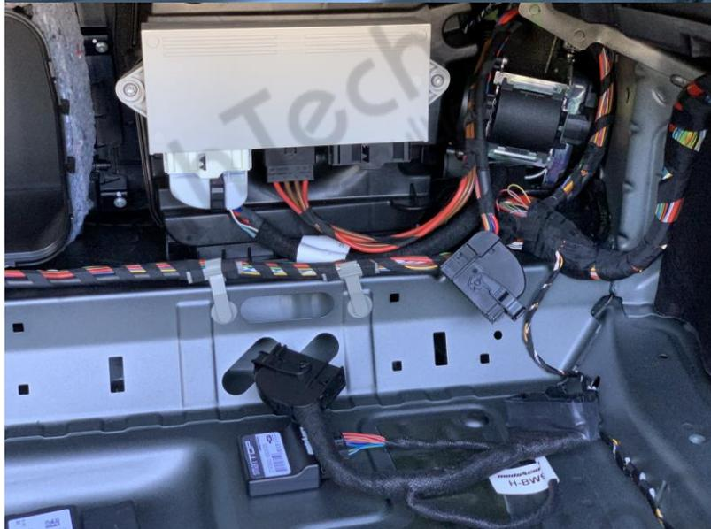
11. La prise illustrée dans un état déconnecté. Branchez la fiche d'origine avec la prise correspondante sur le faisceau de câbles du module, puis connectez la fiche du faisceau de câbles au contrôleur de toit. Assurez-vous que les leviers de verrouillage se rabattent et se verrouillent en place en toute sécurité.
