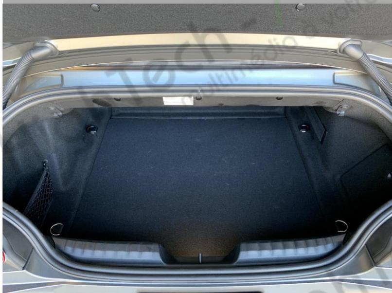
1. Commencez avec le toit fermé, la voiture déverrouillée et le contact complètement coupé. Ouvrez le coffre (hayon) et soulevez et retirez le plancher de la moquette.
