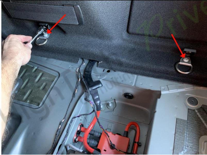
5. Retirez les deux vis Torx sur le côté droit du coffre. Afin de soulever les capuchons en plastique, insérez délicatement un petit couteau ou un tournevis et poussez latéralement et vers le haut.
