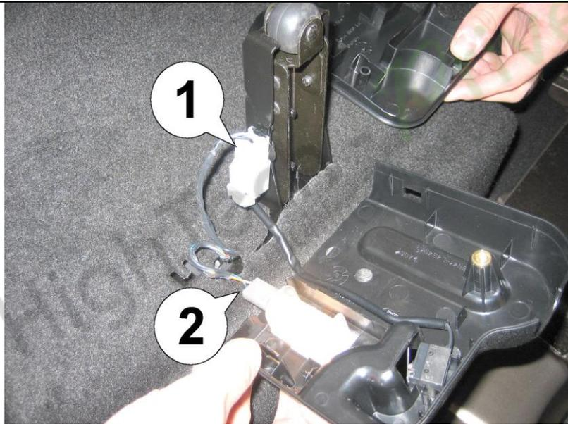
3. Ouvrez le boîtier en plastique et débranchez les fiches de l'interrupteur (1) et de la lumière (2).
