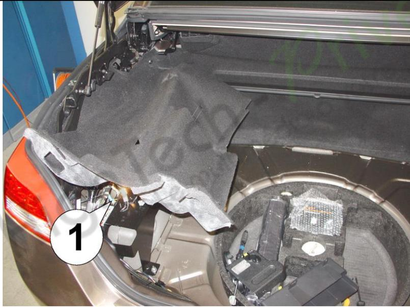
5. Desserrez tout le cache gauche et soulevez-le pour accéder au contrôleur de capote (1) en dessous. Il est protégé par un autre couvercle en plastique.
