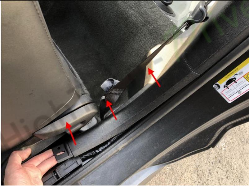
7. Tirez maintenant le panneau latéral vers le centre de la voiture (flèches). Il doit être complètement retiré pour accéder au contrôleur supérieur.
