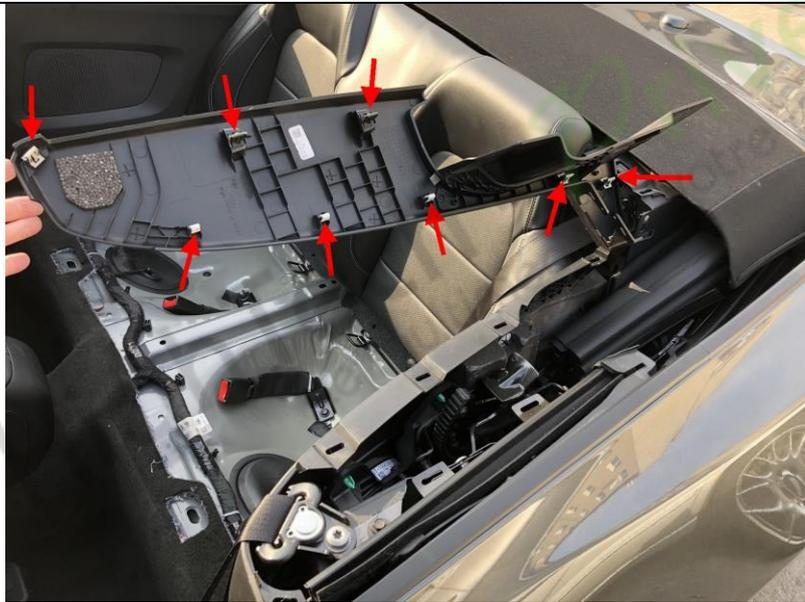
5. Maintenant, le capot supérieur entier peut se détacher. Ici (flèches) sont les clips à pression qui le maintenaient en place.
