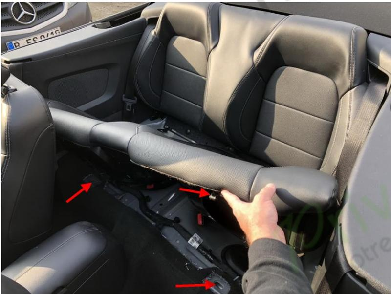
2. Retirez le siège arrière en tirant vers le haut à l'avant. Il est enclenché (voir flèches).
