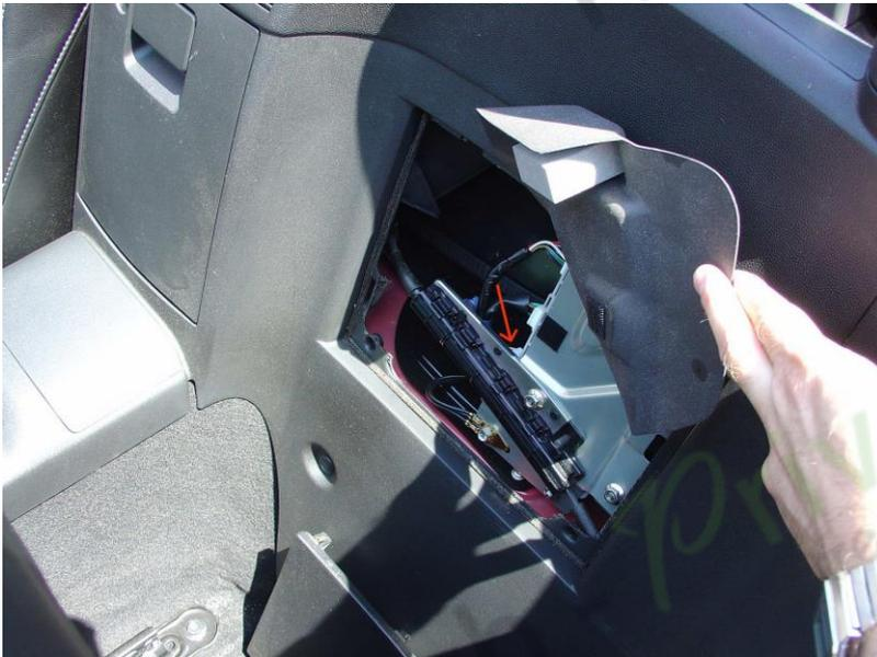
2. Soulevez le rembourrage pour révéler le contrôleur supérieur convertible. Le bouchon inférieur (marqué d'une flèche) devra être retiré à l'étape suivante.
