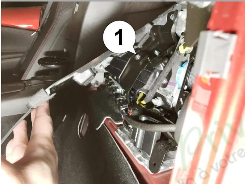
4. Il est maintenant possible de tirer le couvercle du mur arrière vers l'avant et de regarder en dessous. Certains supports en métal noir avec un écrou argenté très distinctif sur le dessus (1) doivent être visibles.
