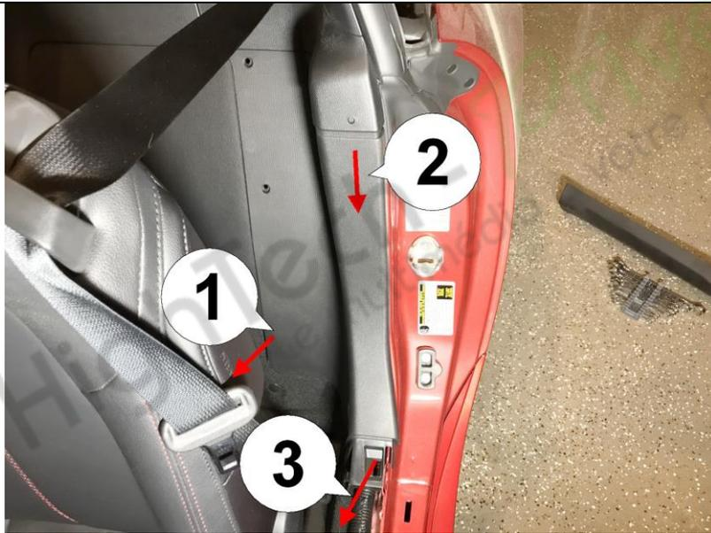
3. Retirez la pièce latérale en tirant d'abord doucement sur le coin inférieur gauche (1), puis vers le bas (2) et enfin vers l'avant de la voiture (3). Il est également enclenché en place avec quelques autres pincettes métalliques.
