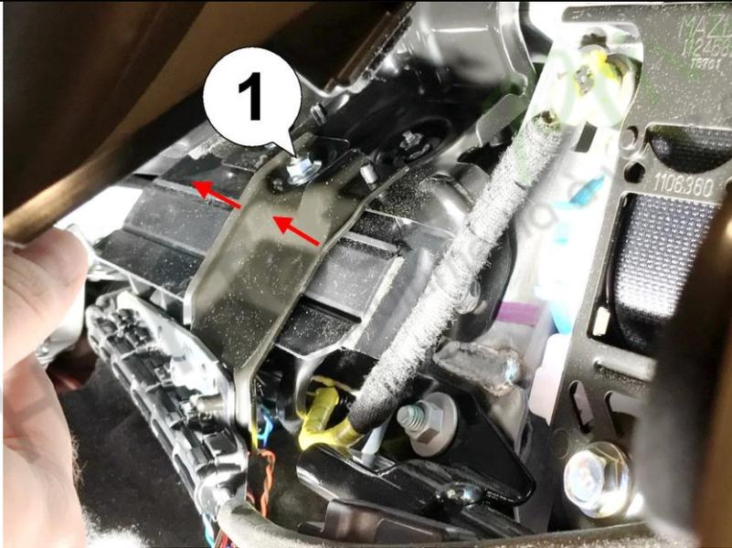
5. Retirez l'écrou (1), puis abaissez le support métallique en le retirant d'abord des boulons (voir flèches). Directement en dessous se trouve un couvercle en plastique avec deux plis / charnières.
