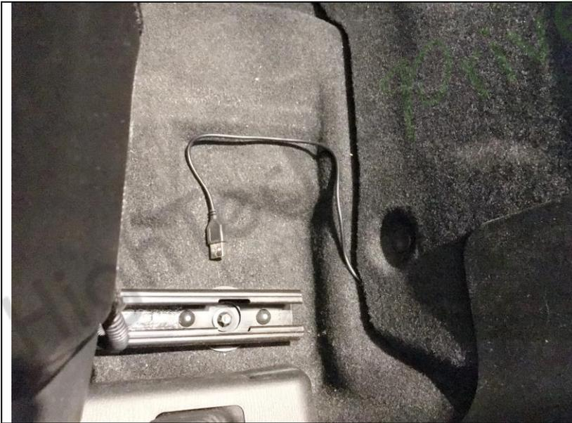
12. Nous vous recommandons de connecter le câble USB et de le faire descendre dans une zone accessible afin de pouvoir utiliser un ordinateur portable pour des mises à jour et une configuration faciles plus tard.
