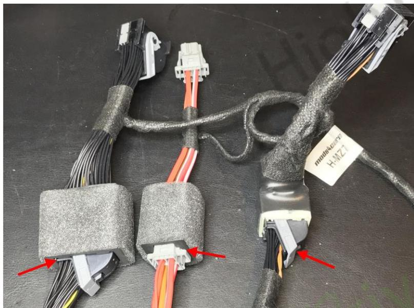
8. L'adaptateur de câblage Mods4cars a trois prises. Les deux enveloppés de mousse sont conçus sur mesure car il n'y a pas de pièces OEM. Veuillez vous assurer d'insérer les deux bouchons de gauche à fond comme indiqué (voir les flèches) en utilisant une certaine force et que le levier de verrouillage sur la prise de droite se relève et le verrouille en place.
