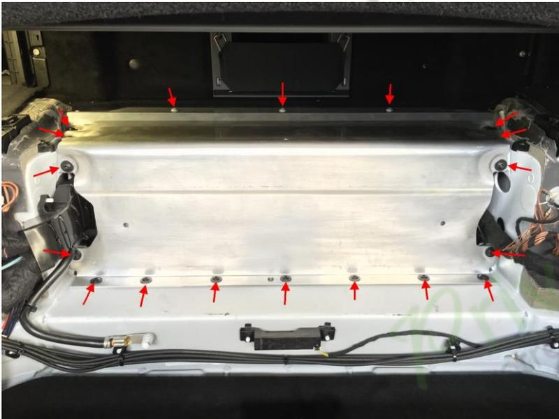
2. Sous la couverture du tapis, il y a une grande plaque en aluminium. Il est fixé avec les 18 vis torx marquées. Retirez-les tous.
