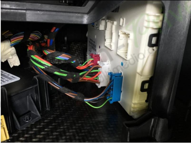
7. Le contrôleur supérieur illustré avec les deux bouchons de droite retirés.
