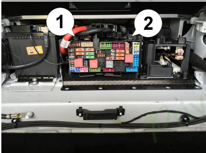
4. Sous la plaque d'aluminium se trouve une boîte à fusibles. Retirez les deux vis Torx (1) et (2).
