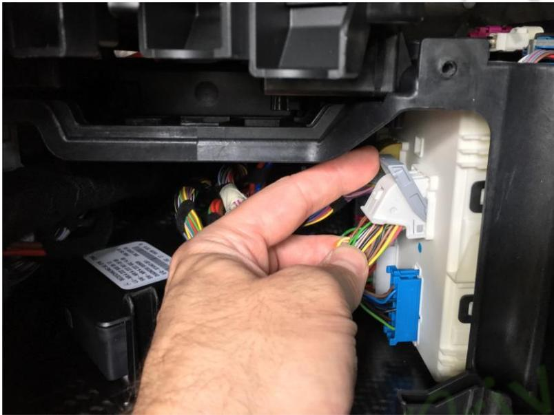
6. Les trois fiches de la rangée supérieure du boîtier de commande supérieur doivent être retirées. Les deux droits sont fixés avec des leviers de verrouillage qui doivent être relevés comme indiqué pour les éjecter.
