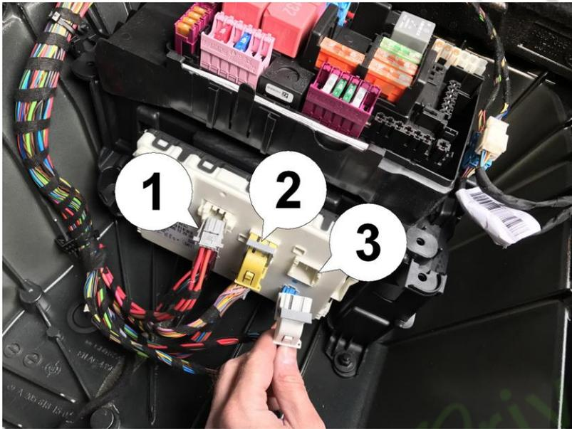
8. Pour une meilleure visualisation, cette photo montre le même contrôleur supérieur exposé sur une Classe C: Retirez le bouchon gris (1) en serrant les leviers de verrouillage des deux côtés tout en le faisant bouger. Relevez les leviers de verrouillage sur le bouchon jaune (2) et le bouchon blanc (3) pour les éjecter.
