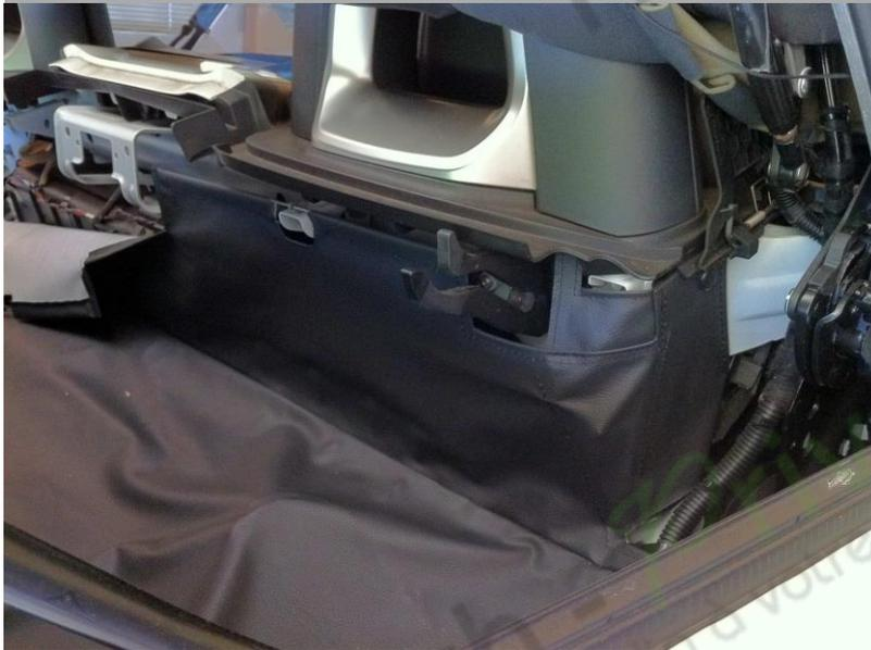
4. Même procédure sur le côté droit. Retirez le rivet et le boulon de verrouillage, puis repliez tout le couvercle.
