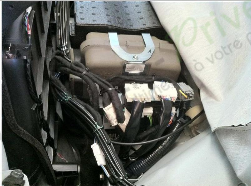
5. De retour sur le côté gauche, l'unité de commande supérieure se trouve directement sous le couvercle qui vient d'être retiré. Il y a deux gros connecteurs blancs avec de nombreux fils fins et un plus petit connecteur gris avec seulement deux fils plus épais qui y vont.
