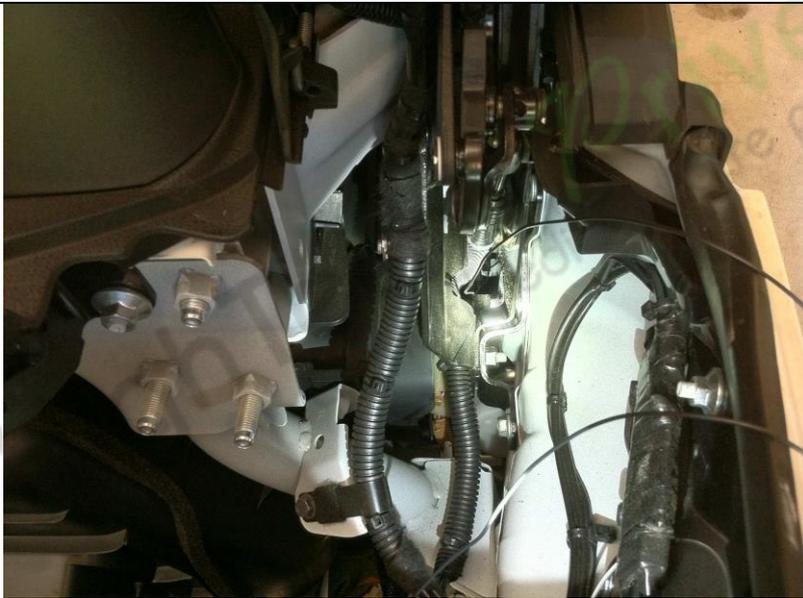
15. Faites maintenant passer le fil noir par l'arrière le long des faisceaux existants sous le mécanisme supérieur. Un support de fil ou de la patience et de l'habileté à diriger le fil vers l'avant seront utiles.
