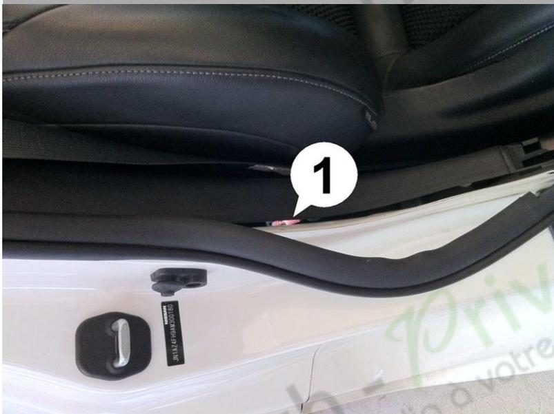
16. Retirez le joint en caoutchouc dans la courbe inférieure du cadre de porte. C'est là que la fiche (1) doit apparaître.
