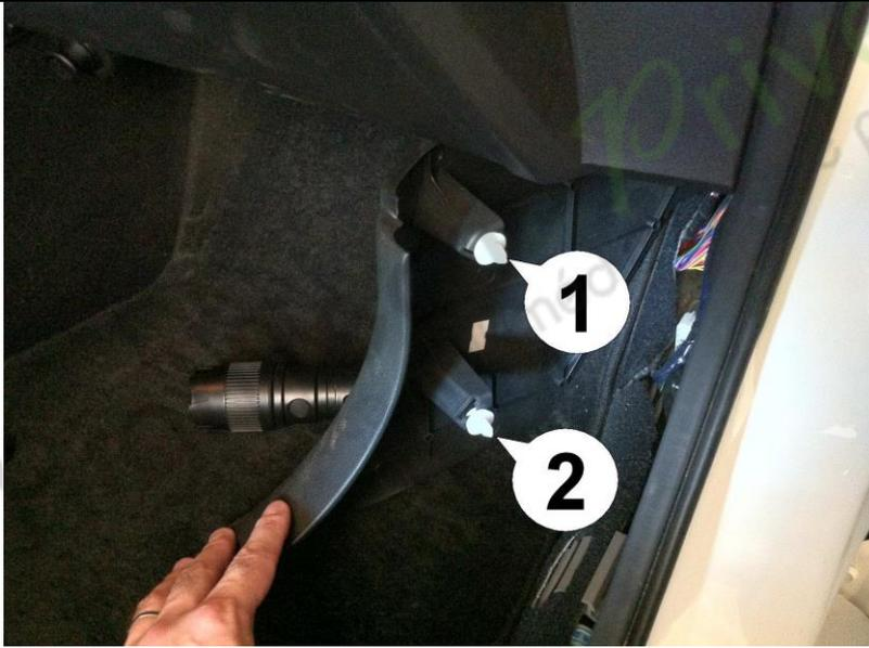
13. Poussez l'avant du panneau de protection contre le centre de la voiture. il est enclenché avec deux boulons (1) et (2).
