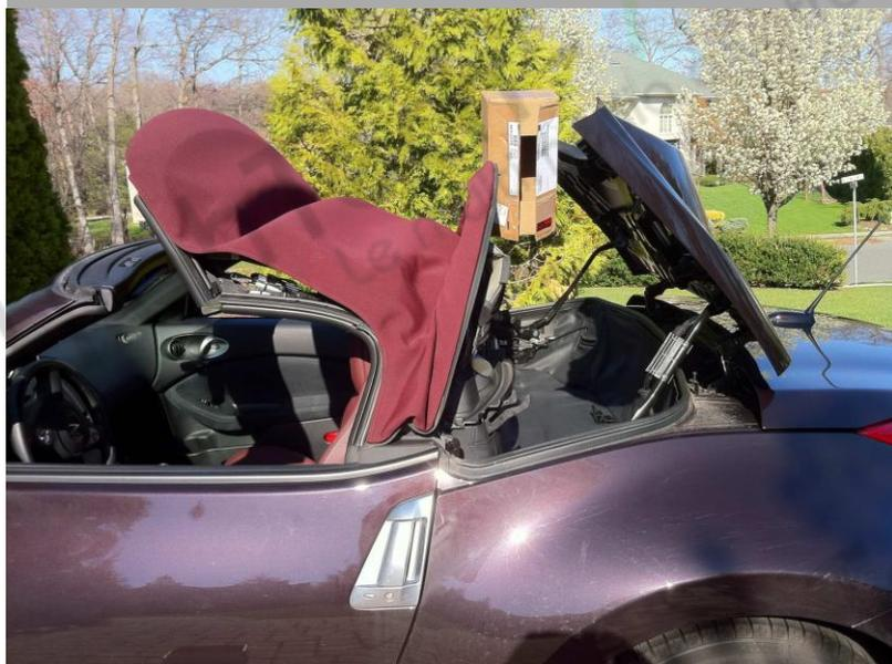
1. Commencez avec le haut complètement fermé. Appuyez et maintenez l'interrupteur supérieur ouvert jusqu'à ce que l'arrière de la capote et le couvercle arrière soient dans leurs positions les plus hautes, puis relâchez et coupez complètement le contact. **IMPORTANT: Fixez le mécanisme de toit avec une boîte en carton ou un morceau de bois dans la position indiquée. Sinon, ils couleront avec le temps et bloqueront l'accès!**
