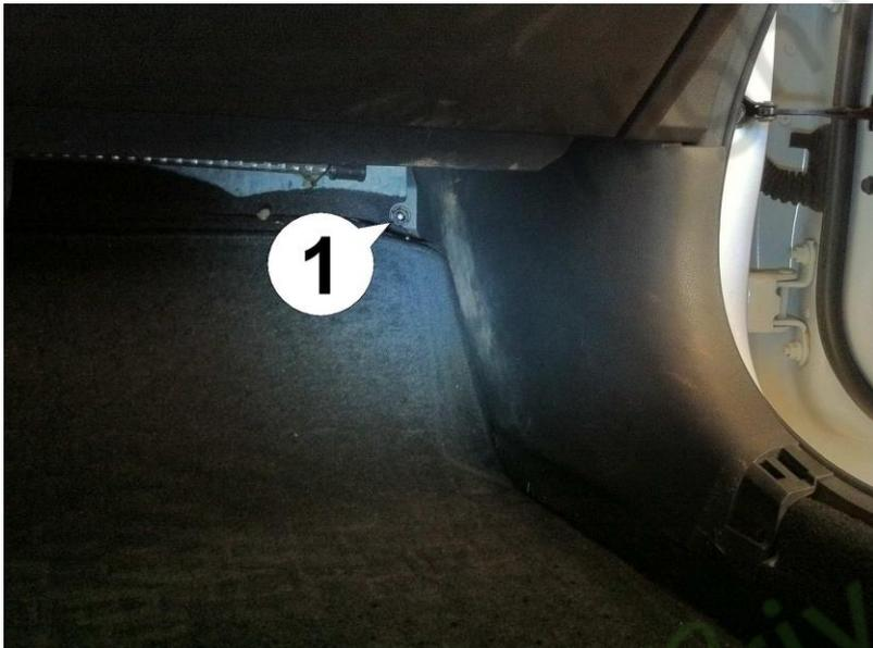
12. Retirez le panneau de protection en dévissant l'écrou en plastique (1). Il peut facilement être retiré à la main.
