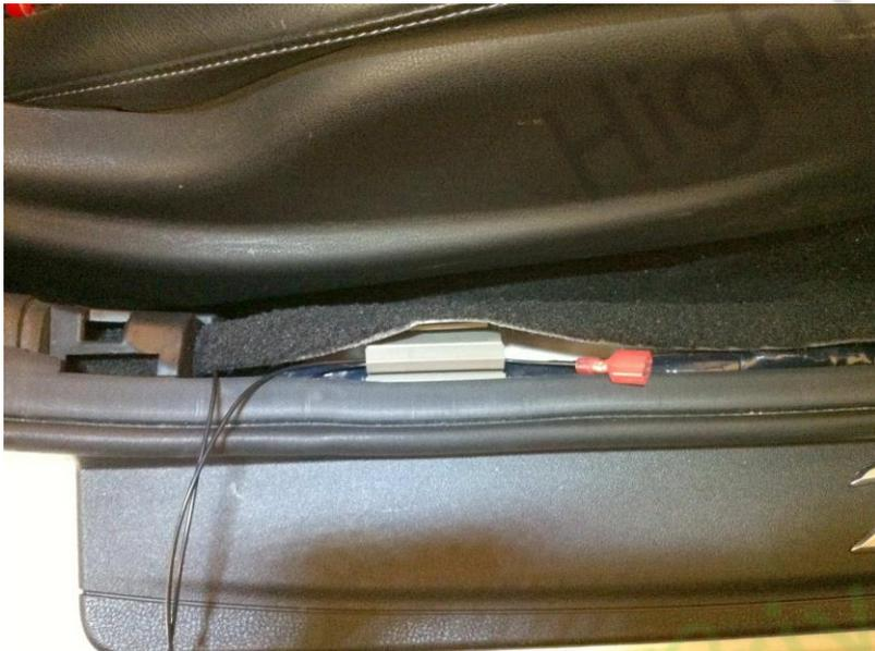
18. Faites passer le fil à travers les grandes ouvertures des supports de tapis jusqu'à l'avant.
