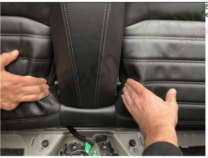
5. L'accoudoir rabattable doit également être retiré. Il est main en place par deux ressorts dans les charnières supérieures.
