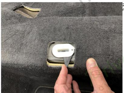
2. Poussez les leviers noirs sur le côté pour désengager le mécanisme et libérer l'avant du siège.
