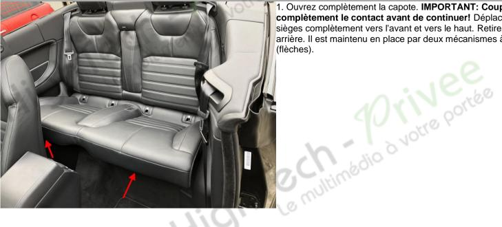
1. Ouvrez complètement la capote. IMPORTANT: Coupez complètement le contact avant de continuer! Déplacez les sièges complètement vers l'avant et vers le haut. Retirez le siè arrière. Il est maintenu en place par deux mécanismes à l'avai (flèches).
