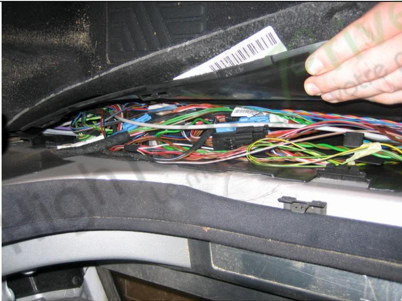
3. Tirez le tapis tout le long du côté gauche. En dessous, il y a une boîte de harnais de fil noir. Son couvercle est maintenu en place par des languettes en plastique. Déclipez les languettes et tirez le couvercle en plastique vers le haut.
