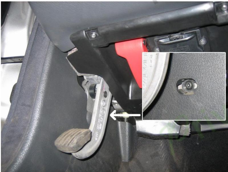
2. Une vis torx (cachée sous un capuchon en plastique) maintient le panneau latéral en place. Soulevez le petit couvercle ovale, puis dévissez-le. Retirez le panneau latéral en le poussant vers l'extérieur et vers le bas. Faites attention à la façon dont il s'interconnecte avec les autres pièces, afin de pouvoir le réinstaller correctement plus tard.
