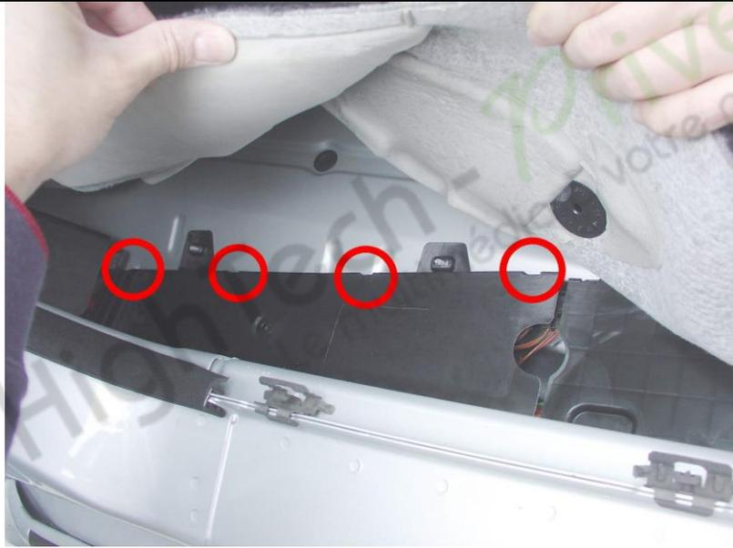
3. Tirez le tapis tout le long du côté gauche. En dessous, il y a une boîte de harnais de fil noir. Sa couverture est maintenue en place par des languettes en plastique (marquées de cercles rouges). Déclipez les languettes et tirez le couvercle en plastique vers le haut.
