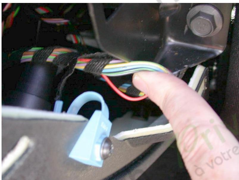
11. Sous le panneau se trouve un faisceau de câbles avec un fil rouge uni. Il s'agit du fil d'alimentation à exploiter avec le connecteur à sertir. Si vous ne pouvez pas accéder au fil de cette façon ou si le harnais est trop court, il est préférable de retirer soigneusement l'interrupteur d'éclairage comme expliqué à l'étape suivante. Tiré des forums Benzworld avec merci à chris-h pour la rédaction!
