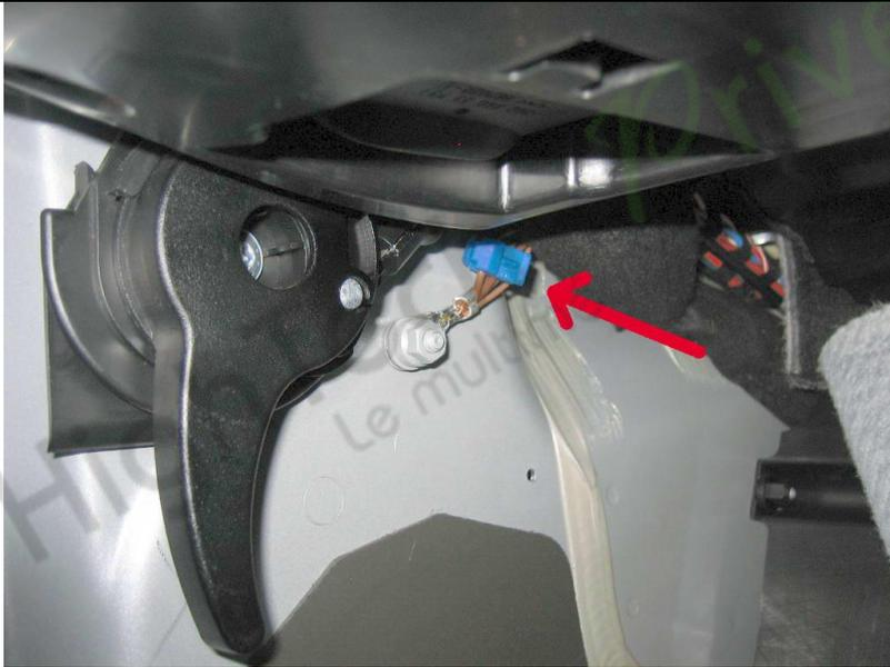
5. Pour obtenir la connexion MISE À LA TERRE du module, fixez un T-Tap BLEU à l'un des fils BRUN PLAIN qui vont directement au boulon du châssis derrière le levier de déverrouillage du capot.
