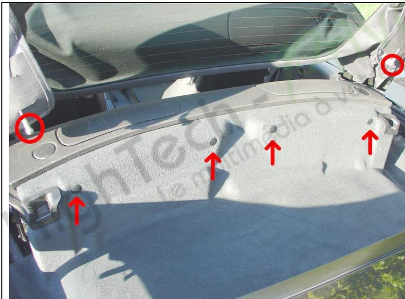
12. Remettez le tapis en place et fixez-le avec les bouchons noirs. Rebranchez les extrémités des fils de retenue sur les joints à rotule.
