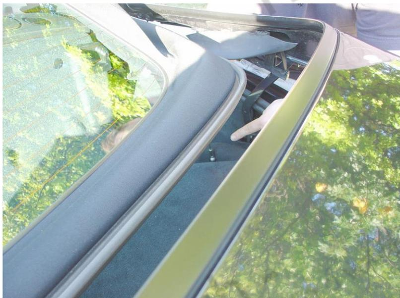
2. Repérez les fils de maintien et les articulations à rotule qui les retiennent. Les joints sont au bas des fils.
