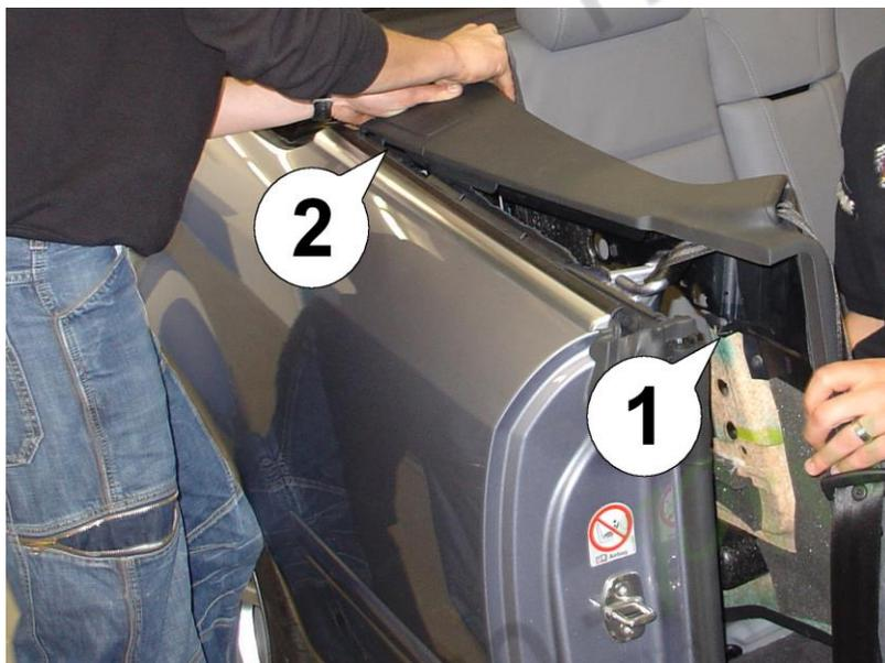
2. Retirez le panneau latéral arrière: tirez d'abord vers le centre de la voiture (1), puis soulevez et faites glisser vers le haut et vers l'avant. Tirez simultanément le dossier (là où la vis Torx a été retirée plus tôt). Le panneau latéral vient d'être enclenché et peut être soulevé le long du bord en caoutchouc (2). Directement derrière le panneau se trouve le boîtier de commande de toit.
