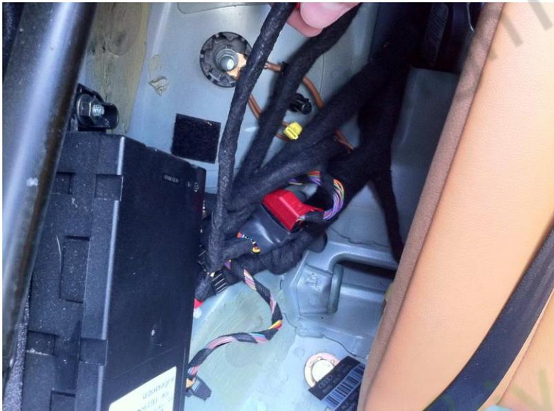
6. Connectez la fiche rouge du faisceau de câbles smartTOP au contrôleur supérieur.
