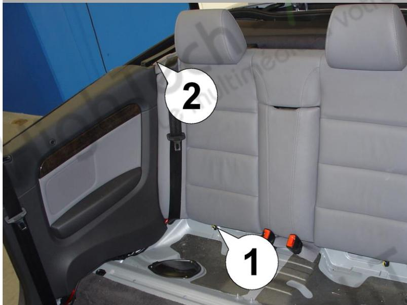
1. Mettez le contact et ouvrez complètement le toit. Commencez ensuite à fermer le toit et arrêtez-vous lorsque le couvercle arrière est complètement ouvert (position verticale). Cela permet d'accéder à la zone marquée (2). **IMPORTANT: Coupez le contact et retirez la clé avant de continuer!** Retirez la banquette arrière (soulevez la partie avant avec force), puis retirez la vis Torx T-30 (1).
