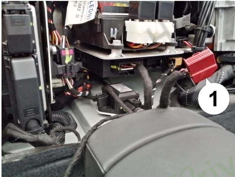
6. Débranchez le connecteur rouge central (1) en poussant la languette de verrouillage en dessous tout en le tirant fermement.
