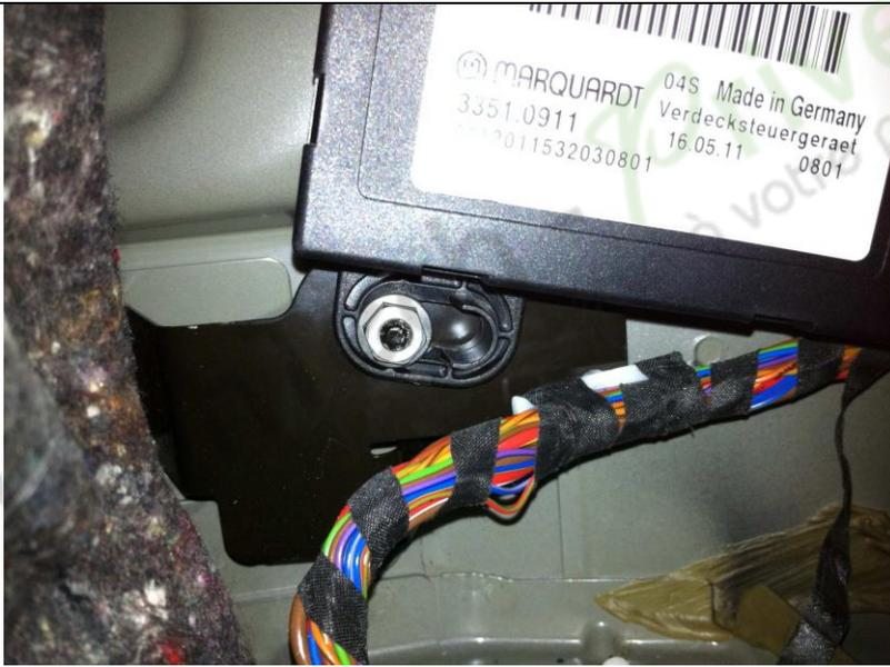
3. Le contrôleur est maintenu en place par deux écrous en haut et en bas. Retirez les deux.
