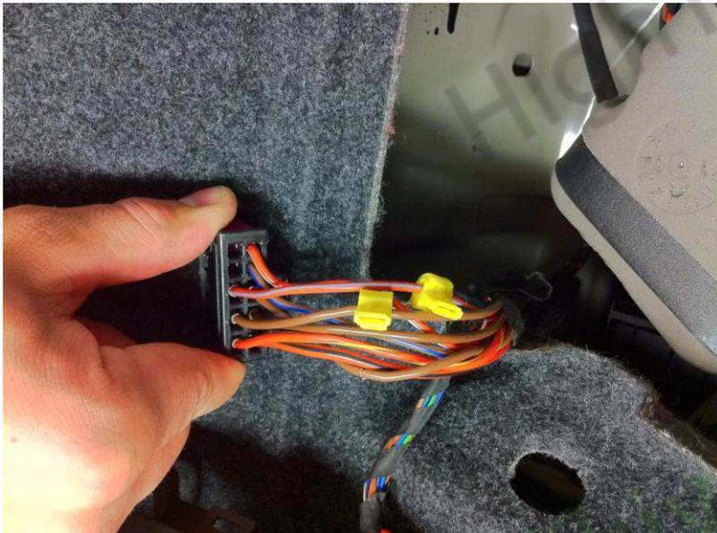
6. Fixez les prises de courant fournies à l'aide d'une pince combinée aux fils allant à la prise noire exactement comme indiqué. Fixez le robinet de fil + 12V directement au fil ÉPAISSEUR ROUGE-GRIS dans la fente de contact n ° 8. Connectez le fil de mise à la terre au fil brun épais dans la fente de contact n ° 9. **9. IMPORTANT:** Il y a plusieurs fils marron! Vérifiez les numéros des emplacements de contact! Ils sont imprimés sur le bouchon noir.
