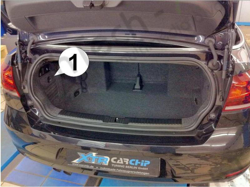
1. **IMPORTANT: Coupez le contact et tirez la clé avant l'installation!** Ouvrez le coffre et retirez le couvercle (1) sur l'ouverture du panneau latéral gauche.
