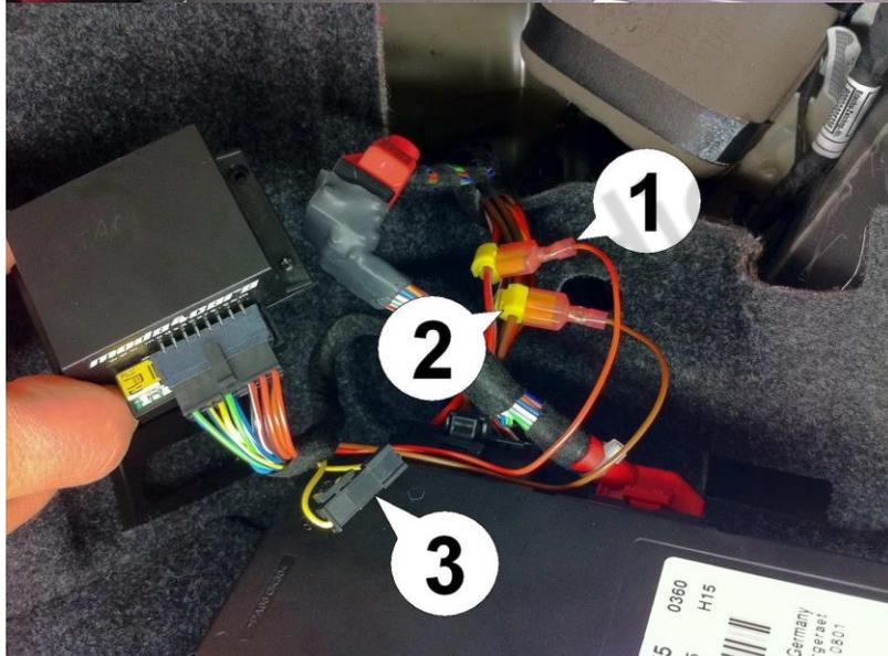
8. Fixez d'abord les connexions d'alimentation, le fil rouge (1) pour + 12V et le fil marron (2) pour la terre. Assurez-vous que la connexion de codage (3) est fermée (fiches connectées). Connectez ensuite le module SmartTOP à la fiche correspondante du faisceau de câbles. Appuyez maintenant une fois sur le bouton de déverrouillage de la télécommande et la LED verte du module devrait CLIGNOTER (voir la section LED InstallAID). Si c'est le cas, toutes les connexions sont bonnes.
