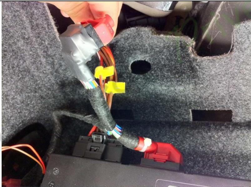
7. Grâce au nouveau harnais plug-and-play SmartTOP, l'installation est très simple! Connectez le faisceau SmartTOP entre la fiche rouge et le contrôleur supérieur.
