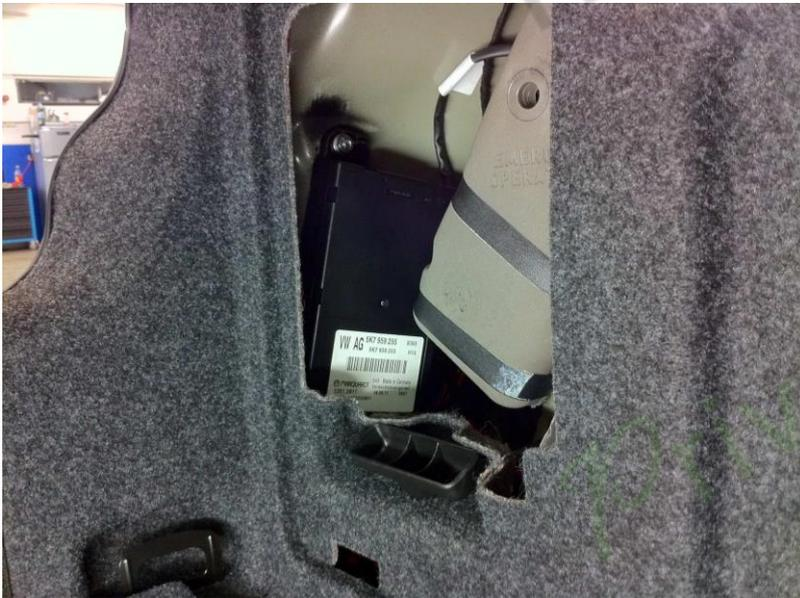
2. À l'intérieur de l'ouverture à gauche se trouve le contrôleur supérieur, marqué "Verdecksteuergerät".
