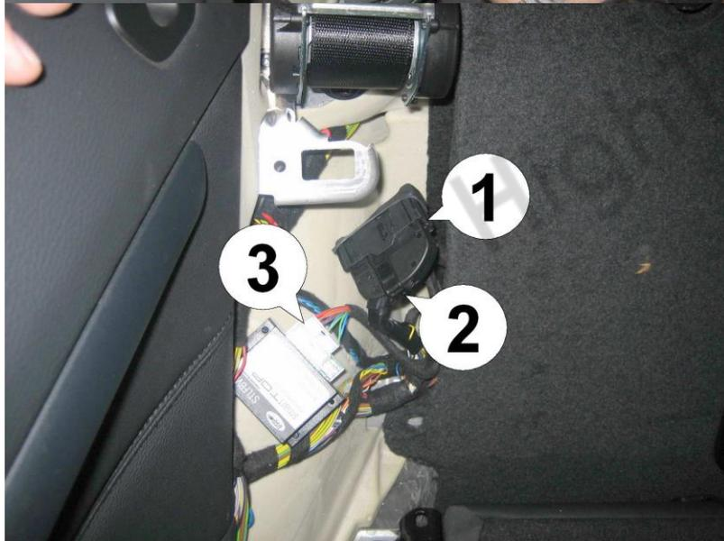
8. Branchez la fiche d'origine sur la prise du faisceau de câbles (1) et assurez-vous également que le levier (2) monte complètement et se verrouille en place. Connectez le module SmartTOP à la fiche du faisceau (3). La LED verte du module doit s'allumer brièvement (le module démarre) et après un appui rapide sur le bouton de déverrouillage de la télécommande, clignoter de manière régulière (activité du bus de données).
