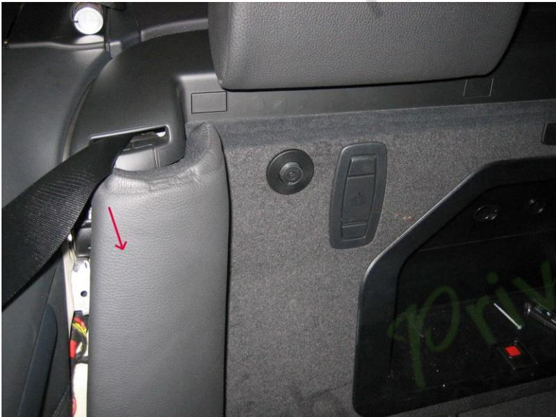
2. Retirez la partie latérale rembourrée arrière droite du siège arrière en tirant dans le sens de la flèche.
