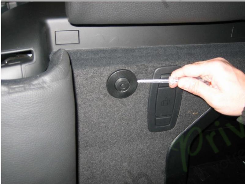
4. Retirez la bague extérieure en plastique en tirant. Il glissera. Ne retirez pas la vis Torx au milieu du noyau en caoutchouc.
