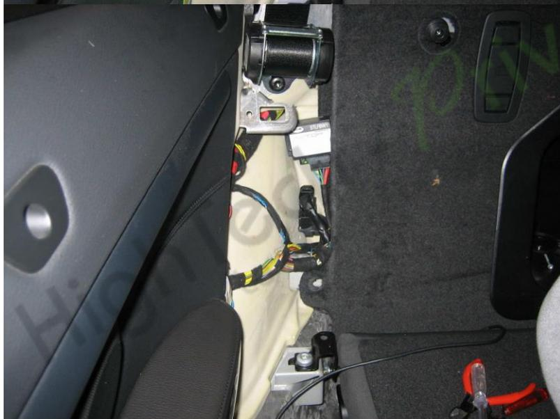
9. Rangez le module et les connecteurs dans le coin, puis réinstallez le panneau arrière et la pièce latérale. Terminé. Nous vous recommandons de laisser le cordon USB connecté au module et accessible (derrière le dossier ou sous le siège arrière) pour les mises à jour ultérieures du micrologiciel ou la configuration facile du module avec un ordinateur portable.
