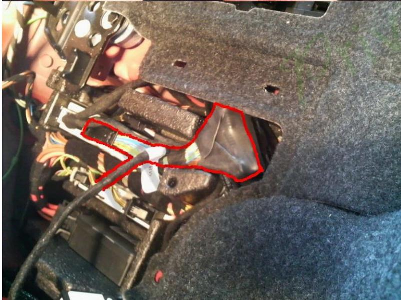
9. La meilleure façon de ranger le faisceau et les connecteurs encombrants dans l'espace restreint est indiquée ici. De cette façon, les couvercles peuvent être réinstallés sans problème.
