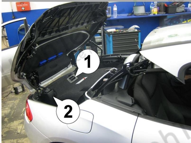
1. Mettre le contact et ouvrir le toit ouvrant dans la position indiquée (position de service), puis arrêter. **Maintenant coupez le contact et tirez la clé avant de continuer!** Du côté droit, entrez dans le coffre et soulevez le séparateur de bagages (1) en position haute. Retirez ensuite le couvercle en plastique (2) en tirant vers l'avant de la voiture. Il n'est maintenu en place que par trois verrous à ressort.
