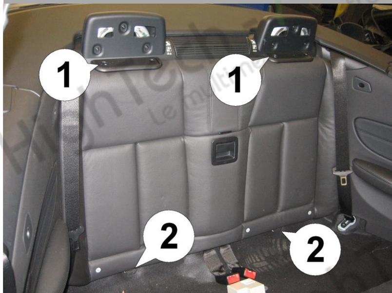
1. **IMPORTANT: Coupez le contact et tirez la clé avant l'installation!** Retirez les deux appuis-tête arrière (1) en poussant la languette à droite du support en plastique tout en tirant sur le repose-tête. Retirez la banquette en tirant vers le haut à l'avant. Il est enclenché. Retirez ensuite les deux écrous (12 mm) au bas du dossier (2).
