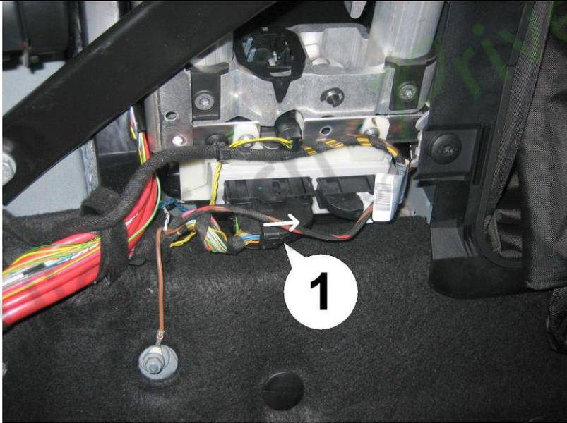
5. Retirez le dossier en tirant vers le bas puis vers le haut. Cela révèle le contrôleur supérieur dans le coin gauche (boîte blanche assise dans une fente avec plusieurs fiches connectées). Retirez le long bouchon noir au milieu en poussant d'abord la languette de verrouillage (1) puis en déplaçant le levier dans le sens de la flèche.
