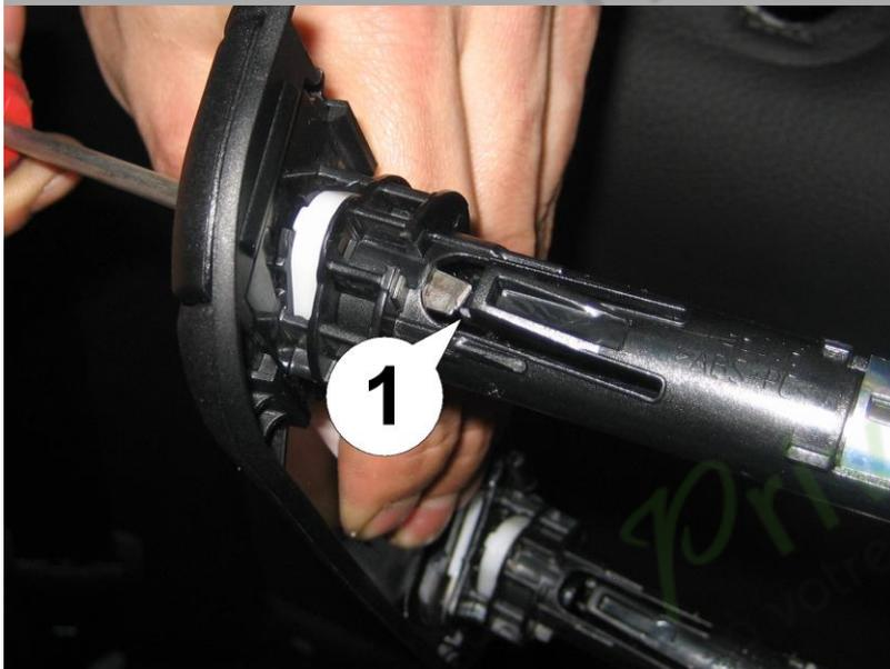
4. Une fois que le support est à environ 1 pouce, il se coince. C'est normal. À partir de là, appliquez une force décente égale entre le côté gauche et le côté droit et retirez-le. Sur cette image, vous pouvez voir le mécanisme de verrouillage.
