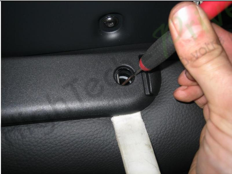
3. Retirez les supports de l'appuie-tête en insérant un tournevis plat dans le trou comme illustré (gauche et droite) et en déverrouillant les loquets en plastique (deux dans chaque trou). Tout en les déverrouillant, appliquez une pression constante vers le haut sur le support jusqu'à ce que le support glisse d'une quantité notable. Tirez à tour de rôle vers le haut sur les coins extérieurs gauche et droit.
