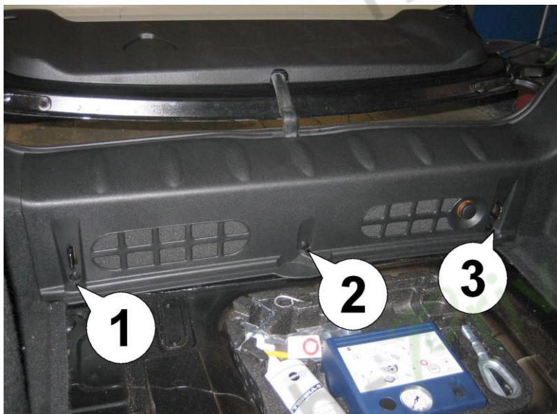
**2.** La caméra est maintenant à l'intérieur de la voiture, pointée vers l'arrière. Retirez les trois rivets au bas de la paroi arrière.
