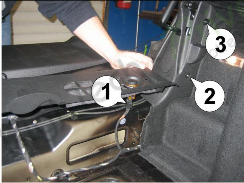
3. Tirez fort vers l'avant et vers le haut pour retirer la pièce murale en plastique. Débranchez le connecteur 12V (1). Retirez maintenant les deux vis Torx (2) et (3).
