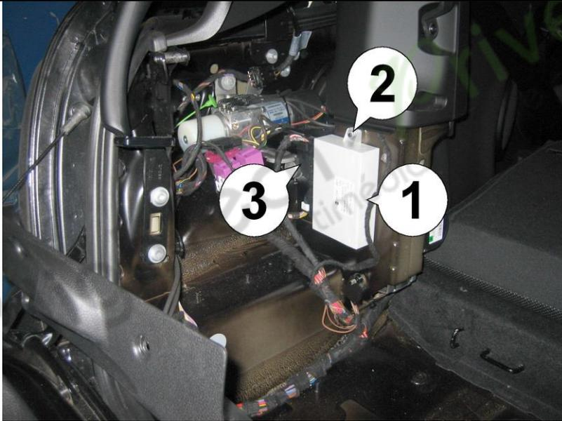
7. La boîte blanche (1) est le contrôleur de capote cabriolet. Retirez l'écrou (2) en haut et desserrez celui en bas, puis inclinez le boîtier latéralement pour accéder au grand connecteur noir (3). Poussez le robinet de verrouillage sur le dessus tout en poussant le levier de verrouillage pour libérer le connecteur de l'unité de commande.
