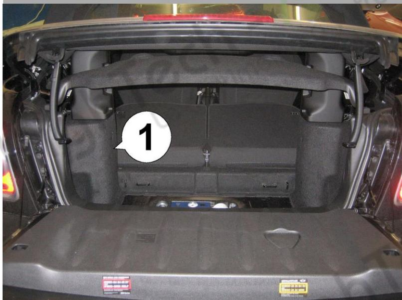
**1. Coupez le contact et tirez la clé avant l'installation!** Ouvrez le couvercle du coffre, soulevez le mécanisme supérieur pour obtenir un meilleur accès. Rabattez les sièges arrière et retirez la partie inférieure du coffre. Retirez deux rivets en plastique avec des épingles de sûreté (1). L'un est au milieu de la pièce latérale recouverte de moquette, l'autre est normalement masqué par le dossier du siège droit.
