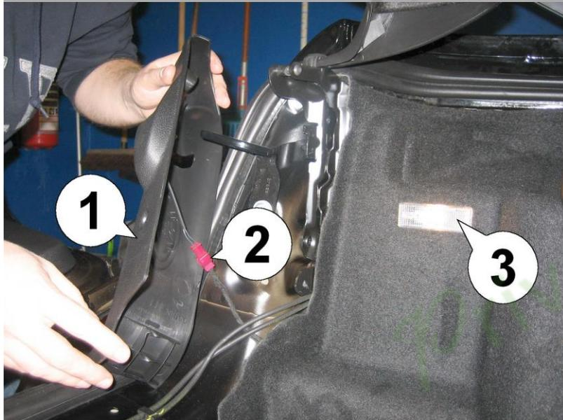
4. Retirez la pièce latérale (1). Laissez les connecteurs rouges (2) connectés et posez la pièce en plastis sur le hayon. Tirez doucement sur le luminaire (3). Il est seulement enclenché.
