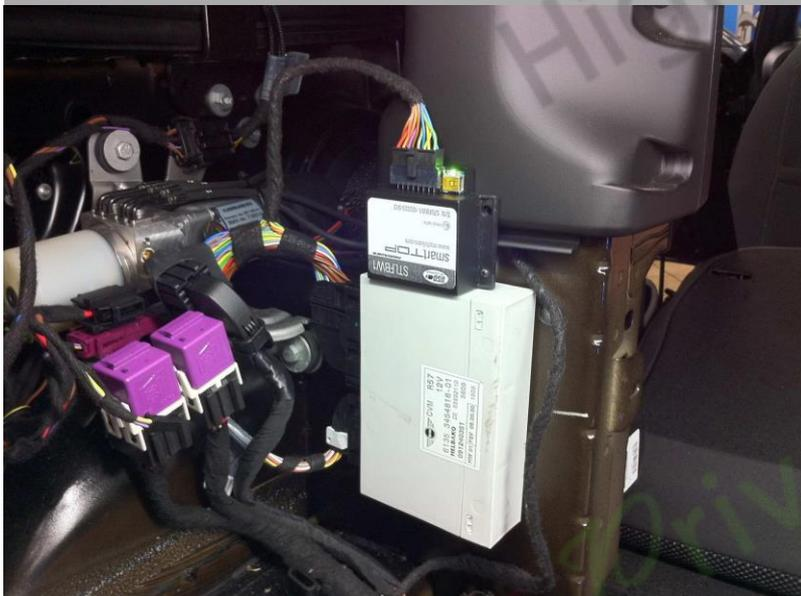
10. Connectez le module SmartTOP à la fiche du faisceau. La LED verte du module doit s'allumer brièvement (le module démarre) et après un appui rapide sur le bouton de déverrouillage de la télécommande, clignoter de manière régulière (activité du bus de données). Nous vous recommandons de laisser le cordon USB connecté au module et accessible pour les mises à jour ultérieures du micrologiciel ou la configuration facile du module avec un ordinateur portable.
