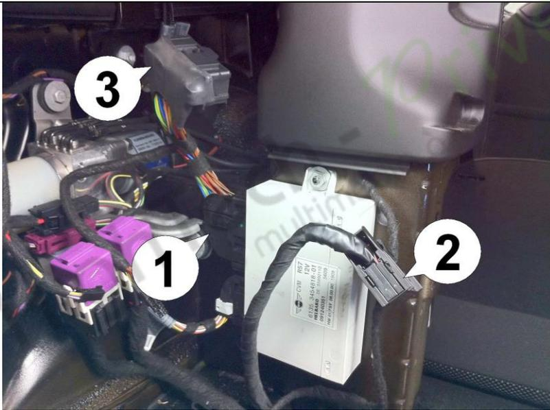
9. Installez le faisceau de câbles fourni en branchant d'abord la fiche correspondante (1) dans la prise du contrôleur supérieur. Assurez-vous que le levier de verrouillage se verrouille en place. Branchez la fiche d'origine (2) sur la prise du faisceau de câbles (3) et assurez-vous également que le levier se verrouille en place. Rattachez le contrôleur supérieur avec les deux écrous.
