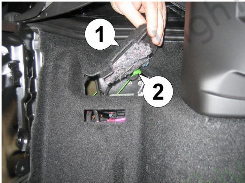
6. Retirez le couvercle de la moquette (1) juste au-dessus de la lumière du coffre et libérez le déverrouillage d'urgence vert (2) de la pièce murale (il y a une fente à l'avant). Retirez ensuite toute la partie du mur recouverte de moquette.
