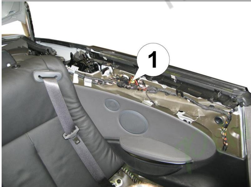
4. Le contrôleur de capote (1) est monté entre la paroi intérieure et extérieure, juste derrière le petit haut-parleur. Dans certains cas, il est monté à l'envers à l'intérieur d'un support métallique qui est maintenu en place par deux vis.
