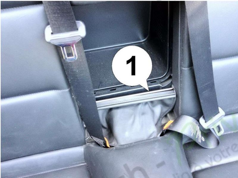
2. Ouvrez le couvercle central (ouverture de ski) dans le dossier et déclipsez le couvercle (1) de la tige métallique. Maintenant, retirez tout le siège arrière en tirant d'abord fort vers l'avant, puis en tirant l'ensemble du siège vers l'avant et vers le haut.
