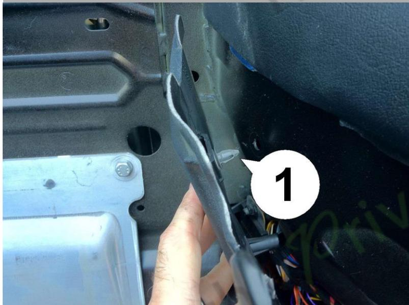
10. Maintenant, le capot latéral peut facilement être rabattu juste assez pour accéder facilement au module de commande supérieur situé derrière. La cheville de verrouillage (1) est représentée ici.
