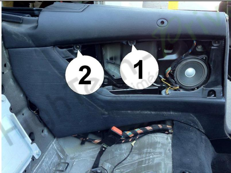
7. Retirez les deux vis (1) et (2) avec une douille de 7 mm.
