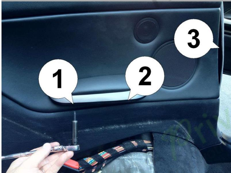
4. Retirez les deux vis (1) et (2), généralement une douille de 8 mm. Tirez ensuite légèrement le joint en caoutchouc (3) comme indiqué.
