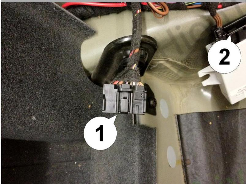
13. Connectez la fiche (1) à la prise correspondante sur le faisceau de module, puis connectez la fiche sur le faisceau de module à la prise (2) sur le contrôleur supérieur. Assurez-vous que les deux loquets sont bien en place.
