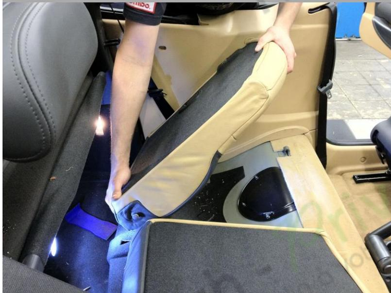
4. Pliez le dossier jusqu'à un angle de 45 degrés, puis tirez vers le haut au milieu pour sortir la charnière centrale, puis tirez vers l'intérieur (vers l'appareil photo sur la photo) tout en remuant de haut en bas pour désarticuler la charnière extérieure.
