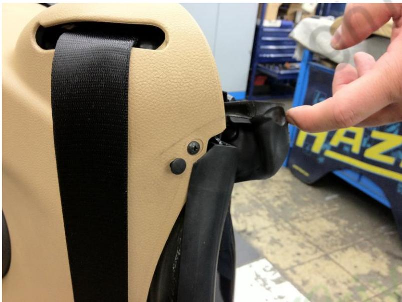
8. Retournez le joint en caoutchouc à l'avant pour trouver une autre vis à tête Philips. Retirez-le.
