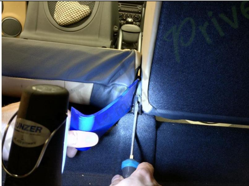
3. Poussez le levier de verrouillage vers le haut avec un tournevis plat. Cela permet de décrocher les pièces du dossier.
