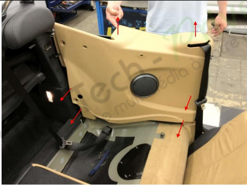
9. Maintenant, en commençant par l'avant, poussez tout le panneau latéral vers le centre de la voiture, puis vers le haut. Il est maintenu en place par quelques verrous à enclenchement visibles sur la photo suivante.
