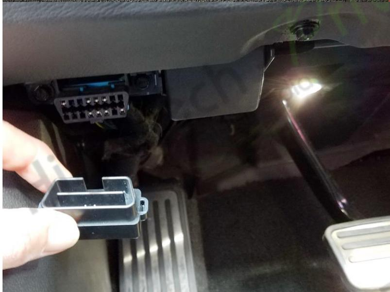
8. Branchez la petite puce OBD dans la prise OBD sous le volant. Ceci est important car c'est la pièce qui permet aux fenêtres de se fermer automatiquement.
