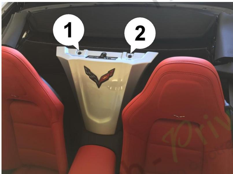
2. Retirez les deux vis Torx T30 (1) et (2) de la pièce centrale du couvercle pour pouvoir la retirer. Il a deux autres dispositifs de retenue en plastique à l'arrière.
