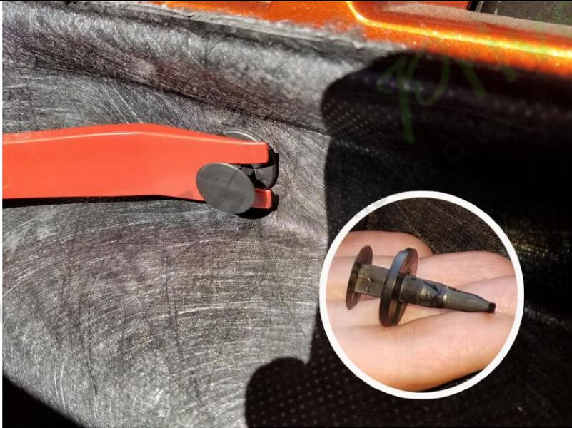
3. Vue de l'arrière où les deux dispositifs de retenue en plastique doivent être retirés. La meilleure façon de les retirer est d'utiliser un tournevis à lame plate ou un outil de retrait de garniture et de retirer la partie centrale. Tirez-les ensuite délicatement vers l'arrière tout en remuant.
