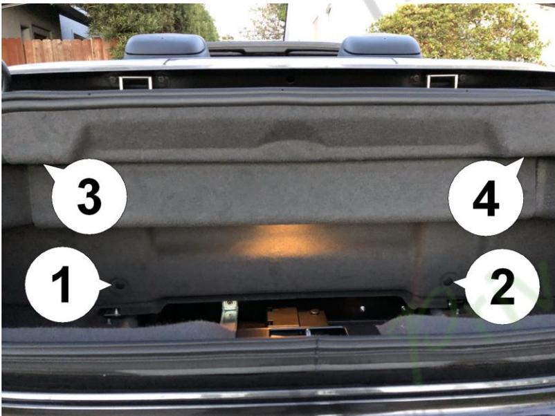
2. Retirez la pièce de couverture maintenue en place par 4 rivets en plastique (1) à (4) en saisissant sous elle à chaque emplacement et en tirant simplement. Les rivets en plastique sortent assez facilement.
