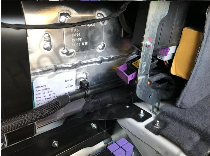
5. La prise illustrée dans un état déconnecté. Maintenant, connectez simplement la fiche d'origine à la prise du faisceau du module et connectez la fiche du faisceau au contrôleur supérieur. Assurez-vous que les leviers de verrouillage violets sont à fond et que toutes les connexions sont sécurisées.
