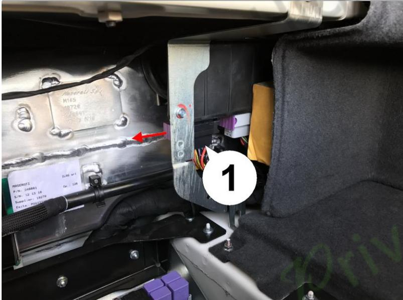
4. Dans le coin droit se trouve le module du contrôleur de capote convertible. La première prise noire (1) doit être débranchée. Saisissez sous le levier de verrouillage violet et tirez-le vers vous. Inspectez celui sur le faisceau de câbles fourni pour une visualisation du mécanisme.
