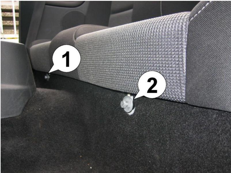
2. Retirez le siège arrière en retirant d'abord les vis (1) et (2), puis en tirant fort et vers l'avant.
