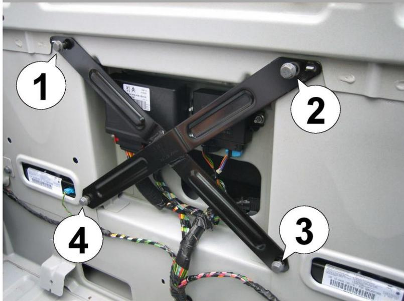
4. Retirez les vis (1) à (4) pour accéder au contrôleur de capote.
