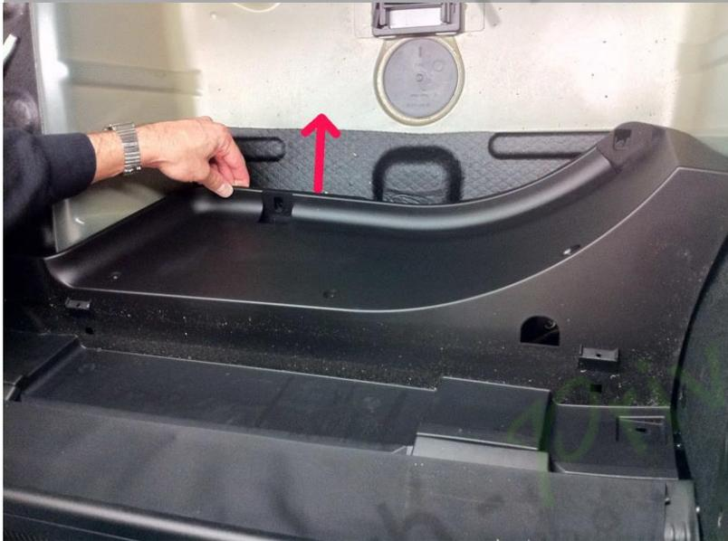
4. Soulevez le couvercle en plastique vers le haut et au-dessus des boulons du bouton, puis tirez-le dans le sens de la flèche.
