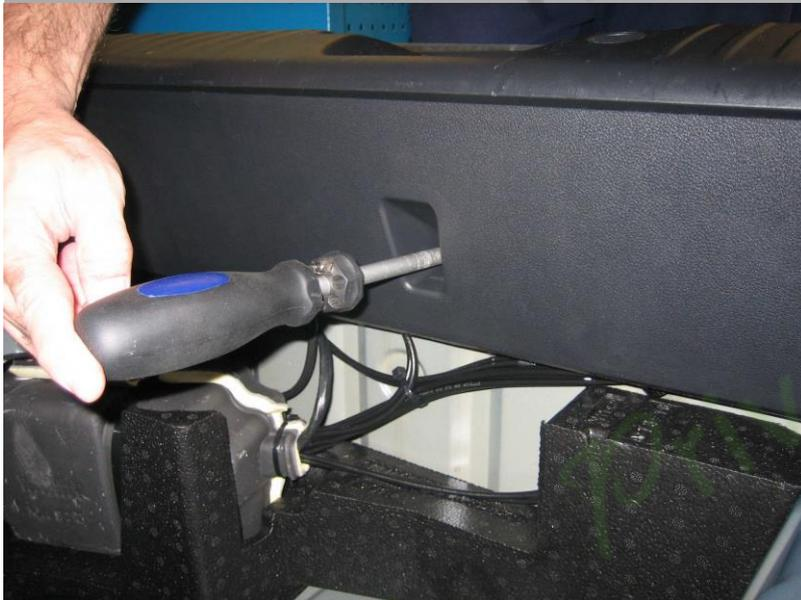
4. Il y a maintenant trois vis à l'intérieur et deux sur le dessus du couvercle en plastique sur le verrou du coffre. Retirez les cinq.
