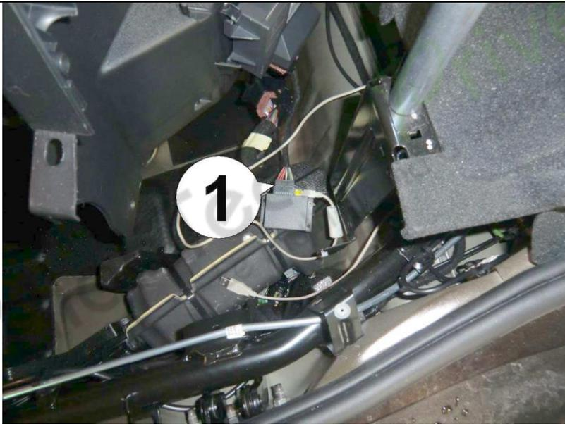
11. Maintenant, connectez la fiche de la voiture à la prise à l'autre extrémité de l'adaptateur de câblage, en vous assurant également qu'elle s'enclenche. Ensuite, connectez le module smartTOP à la petite prise (1) et (facultativement) connectez le câble USB pour une configuration / mise à jour ultérieure via un ordinateur portable sans avoir à tout démonter à nouveau.
