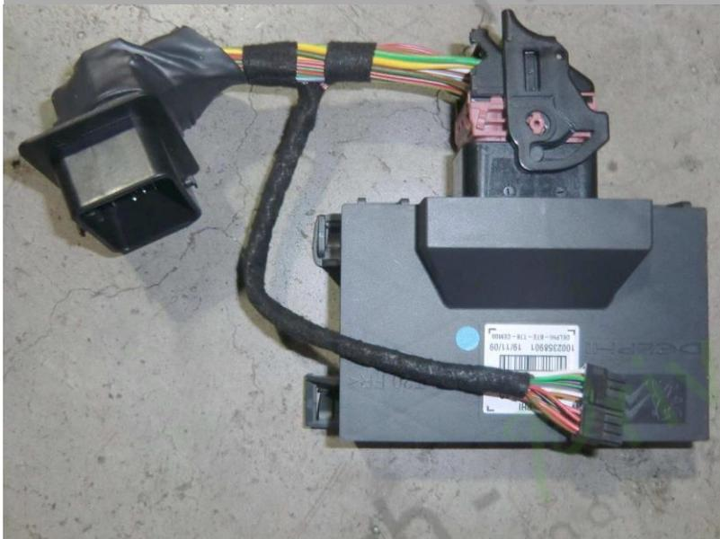
10. Connectez l'adaptateur de câblage fourni à l'unité de commande supérieure. Assurez-vous que la prise s'enclenche et que le levier de verrouillage est en position verrouillée, comme illustré.
