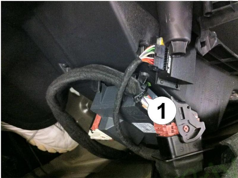
12. Fixez le contrôleur supérieur à sa place, puis rangez le smartTOP et le faisceau de câbles sur le côté du contrôleur supérieur. La meilleure solution consiste à attacher le faisceau de câbles avec une attache à glissière (1) au coin du contrôleur supérieur, de sorte qu'il ne puisse pas être pincé par la mécanique du toit (voir l'étape suivante!).
