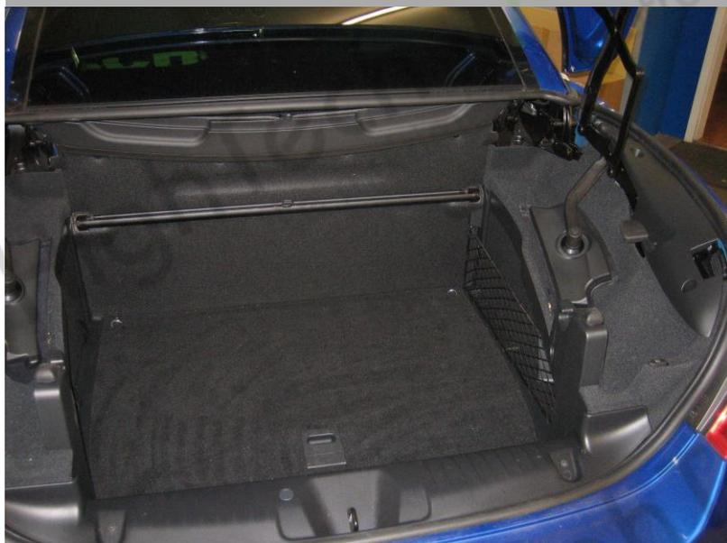
1. **IMPORTANT: Coupez le contact et retirez la clé avant de continuer!** Ouvrez le coffre et retirez le couvercle inférieur.
