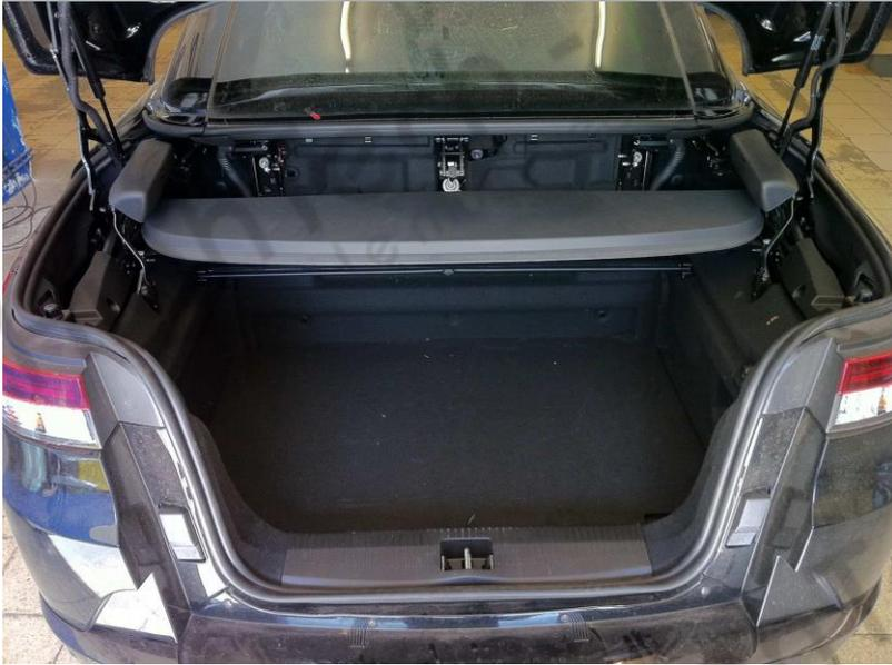
1. Fermez complètement le toit décapotable et ouvrez le coffre. **IMPORTANT: Coupez le contact et retirez la clé avant de continuer!** Videz le coffre et retirez le couvercle inférieur.
