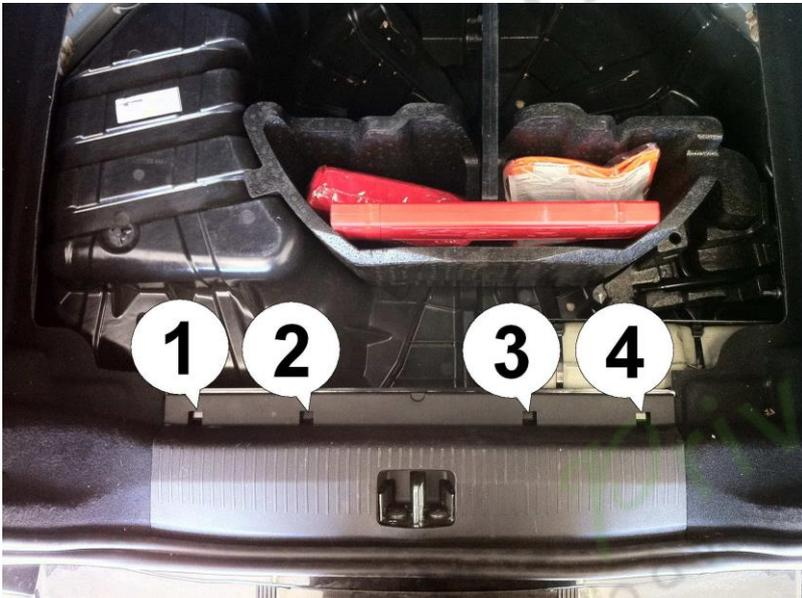
2. Poussez les languettes de verrouillage (1) à (4) tout en tirant fort sur le couvercle en plastique.
