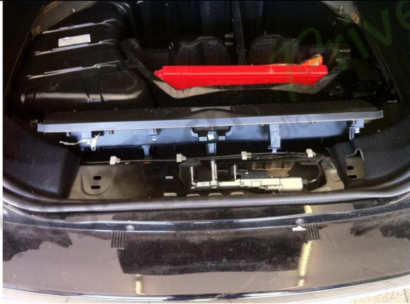
3. Le couvercle en plastique n'est enclenché qu'en place. Aucune vis à retirer.
