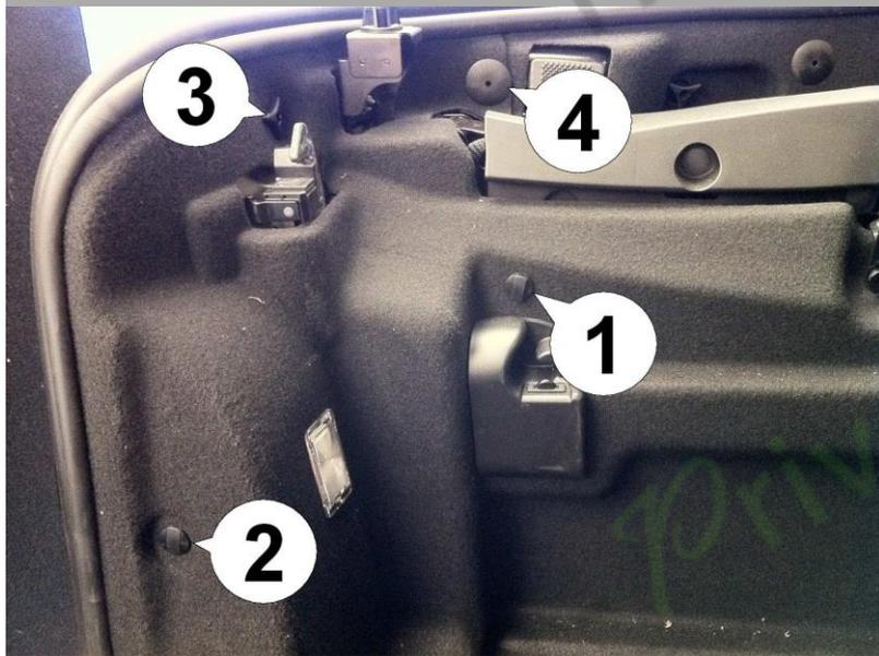
4. Retirez les deux boulons en plastique (1) et (2) en tirant d'abord sur les pièces centrales. Dévissez l'écrou à oreilles à trois côtés (3) et retirez le boulon de tapis (4) en le tirant tout droit.
