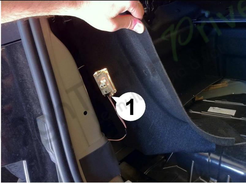
5. Débranchez la petite fiche (1) de l'éclairage du coffre. Poussez la languette de verrouillage sur le côté tout en tirant doucement sur la fiche.
