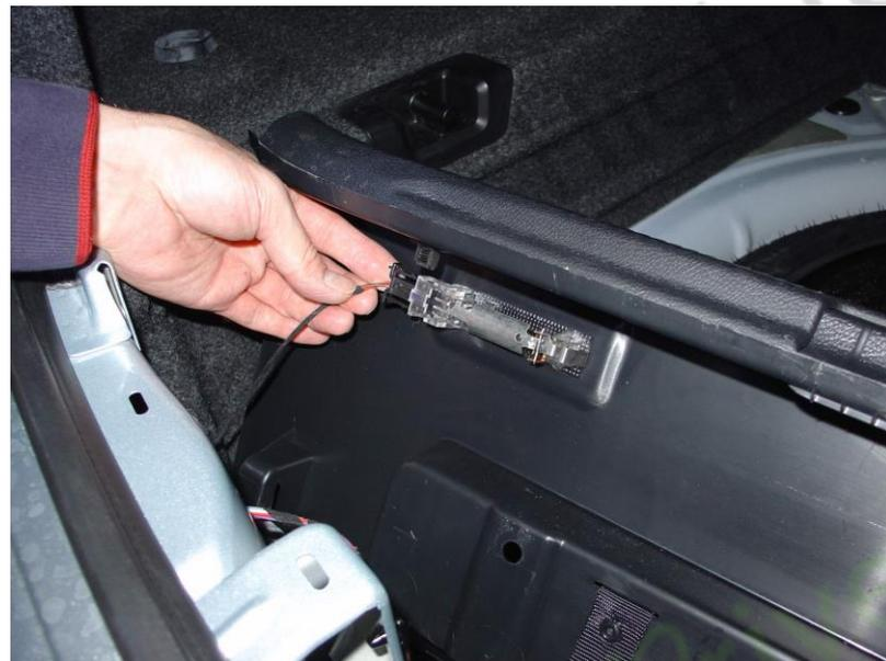
8. Retirez la bande en caoutchouc le long du verrou de coffre, puis retirez tout le couvercle arrière en plastique vers le haut. Faites attention à la lumière du coffre, qui est connectée à un ensemble de fils via une prise amovible. Poussez les languettes ensemble pour libérer son mécanisme de verrouillage tout en tirant.
