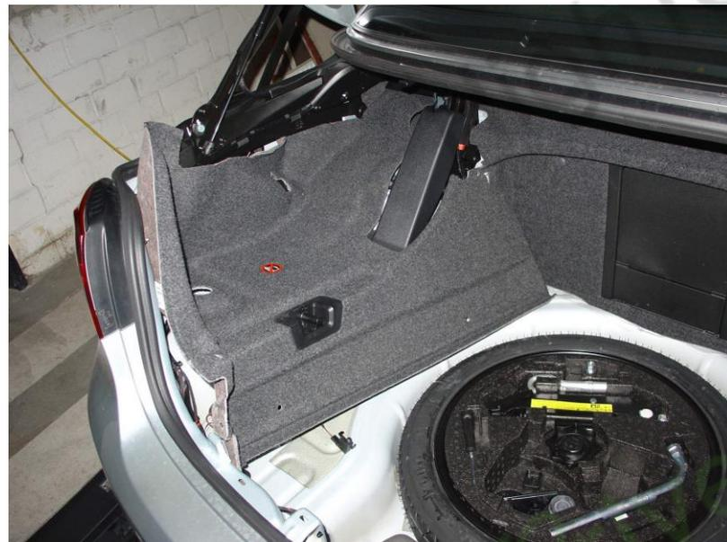
12. Desserrez toute la couverture de tapis gauche et tirez vers le milieu du coffre et vers le haut. Tirez sous le joint en caoutchouc et retirez-le sous le bouchon en haut à gauche. Assurez-vous que tous les boulons de fixation ont été retirés.
