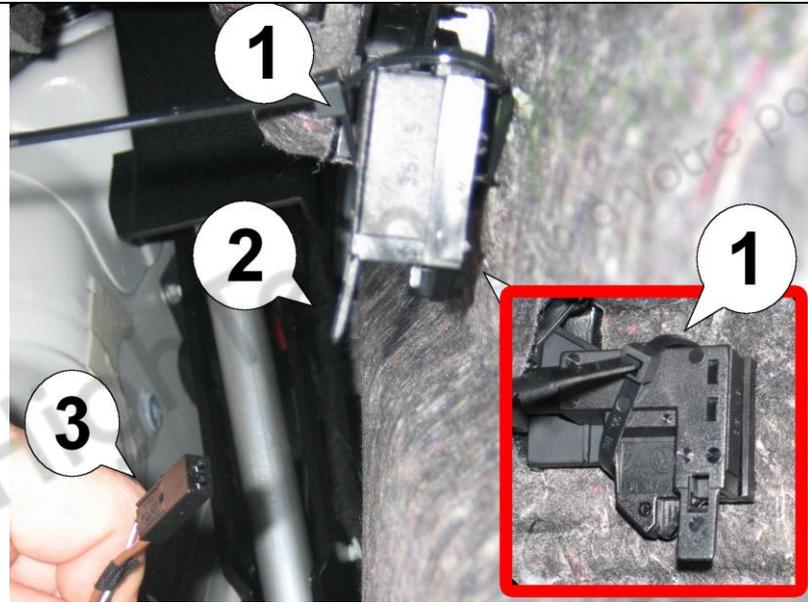
13. Soulevez délicatement le revêtement du tapis et déclipsez l'interrupteur de séparation (1). Il est monté directement sous le mécanisme en plastique où le diviseur se verrouille généralement en place. IMPORTANT: sur certains modèles EOS, le commutateur de séparation des bagages (1) est fixé en place avec un serre-câble. Si tel est le cas, débranchez son connecteur (3) en poussant la languette (2) vers l'extérieur tout en tirant sur le connecteur. Laissez l'interrupteur lui-même en place.
