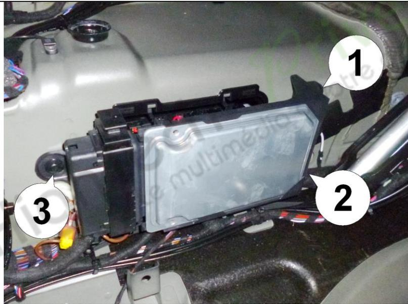
15. Si le contrôleur supérieur n'est pas accessible comme indiqué à l'étape 14 (sur les voitures avec suspension DCC, il y a une autre unité de commande montée devant), retirez simplement les chevilles des boulons de fixation (1,2,3) et retirez l'ensemble du support avec l'unité DCC, jusqu'à ce que vous puissiez accéder au contrôleur supérieur, comme indiqué à l'étape suivante.
