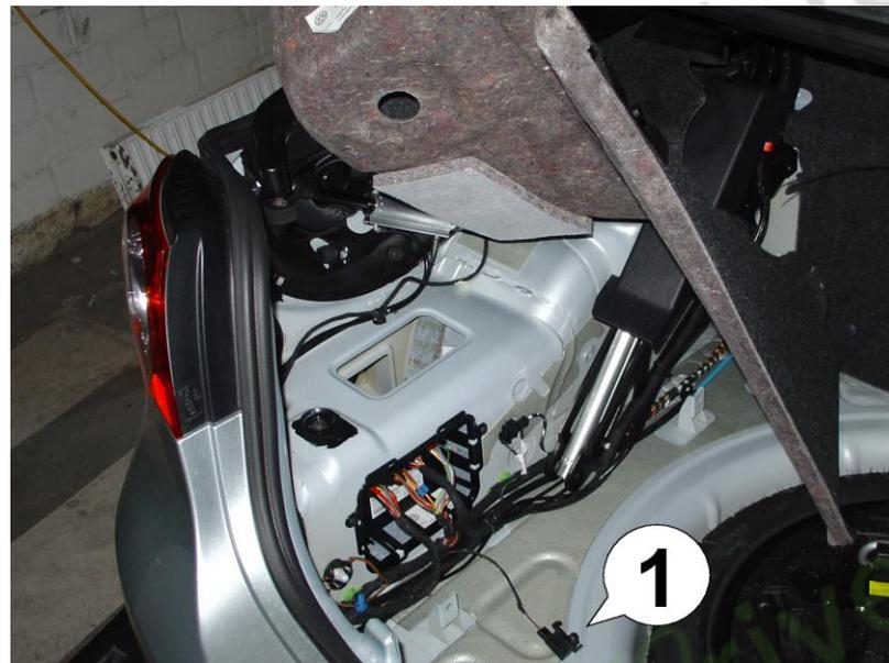
14. Tournez tout le couvercle dans le sens antihoraire tout en le soulevant. Placez ensuite le coin arrière sur la roue de secours ou le couvercle en mousse de polystyrène pour que le couvercle reste en place comme illustré. Le commutateur de séparation des bagages est marqué sur la photo par (1).
