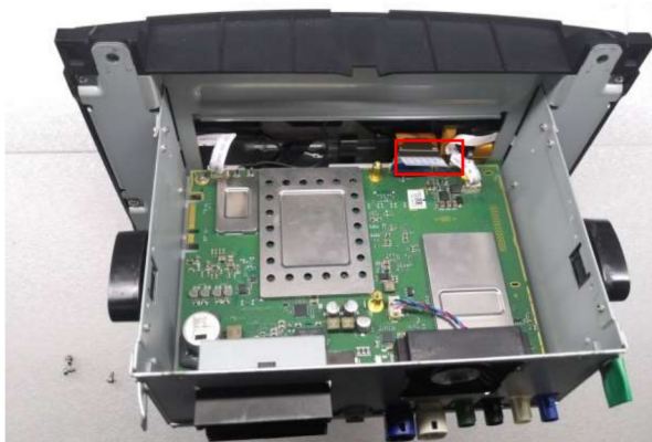
3. Débranchez le câble ruban d'origine de la carte mère, puis insérez le câble ruban d'interface dans le connecteur d'origine (côté bleu tourné vers l'extérieur).
