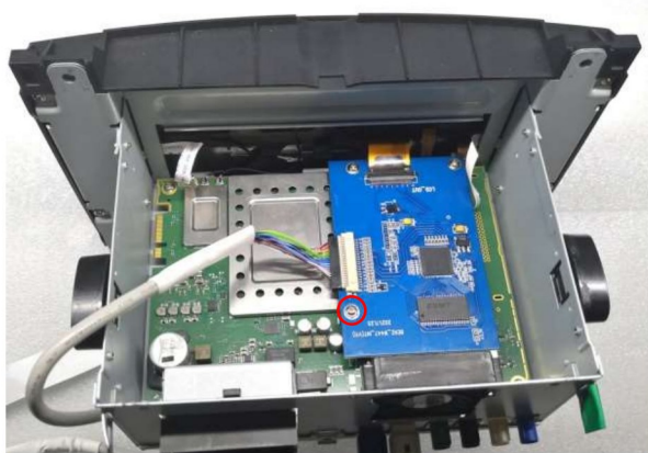
5. Branchez le câble ruban d'origine dans le connecteur situé à l'avant du tableau de commande et resserrez les trois vis.
