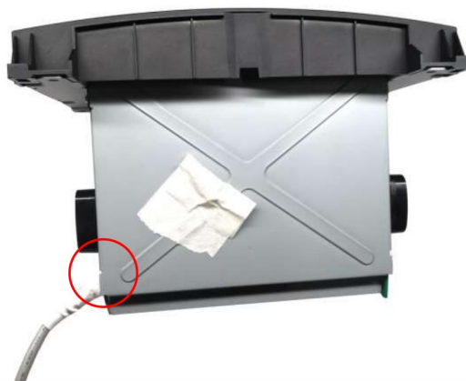
6. Remettez le capot métallique en place et revissez toutes les vis. Faites attention à la position du câble LVDS.
