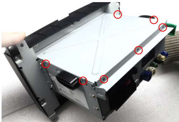
1. Retirez le capot métallique de l'unité radio.
