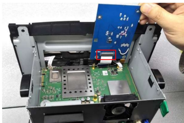
4. Branchez l'autre extrémité du câble plat d'interface dans le connecteur situé à l'arrière du tableau de commande.
