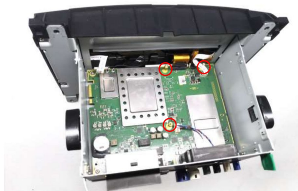
2. Dévissez les trois vis situées dans le cercle rouge et insérez-y les entretoises.
