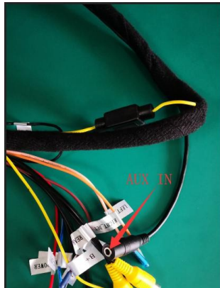
Câble d'entrée AV
